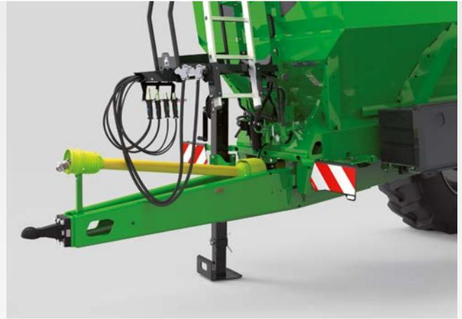
✔ Untenanhängung mit Zugkugelpkupplung K80
