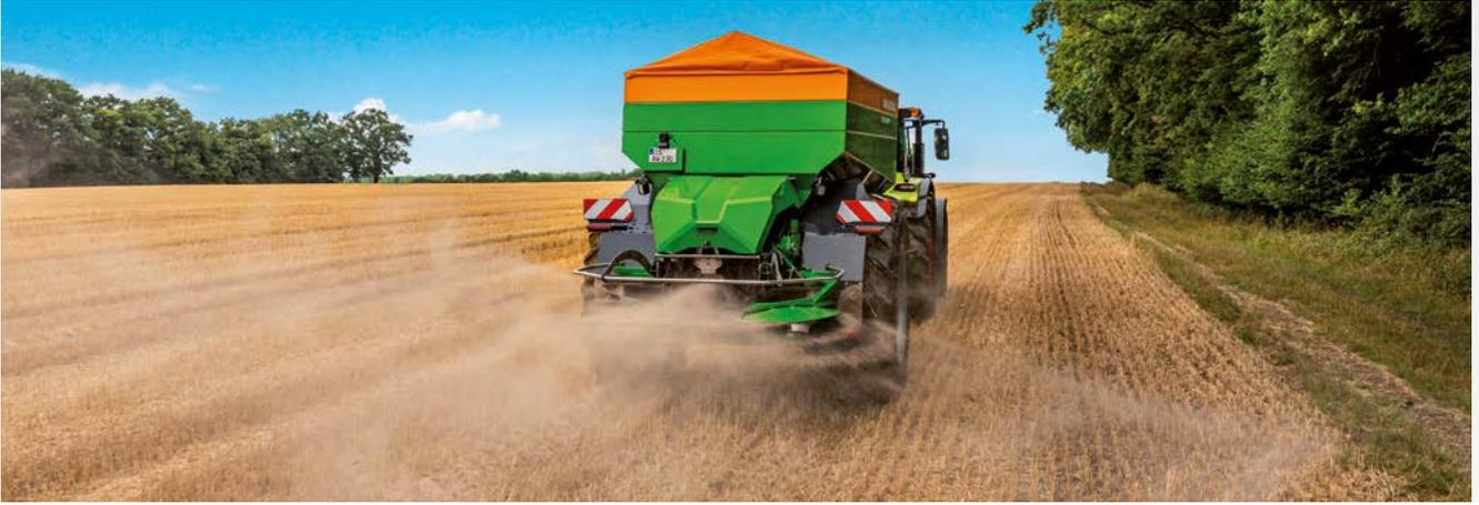
Der neu entwickelte Grenzstreuschirm für Kalk ermöglicht ein exaktes Arbeiten bis zur Feldgrenze
