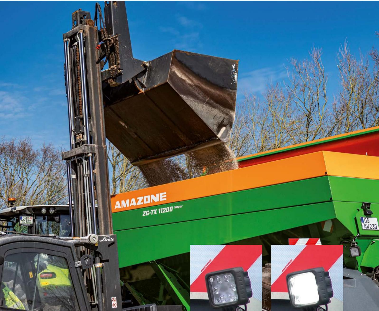
Durch ein Blinken der Arbeitsbeleuchtung wird der Füllstand schon während des Befüllens signalisiert. Leuchtet die Arbeitsbeleuchtung durchgängig ist die Sollmenge erreicht. Eine zweite Person oder mehrmaliges Absteigen zur Kontrolle entfallen.
