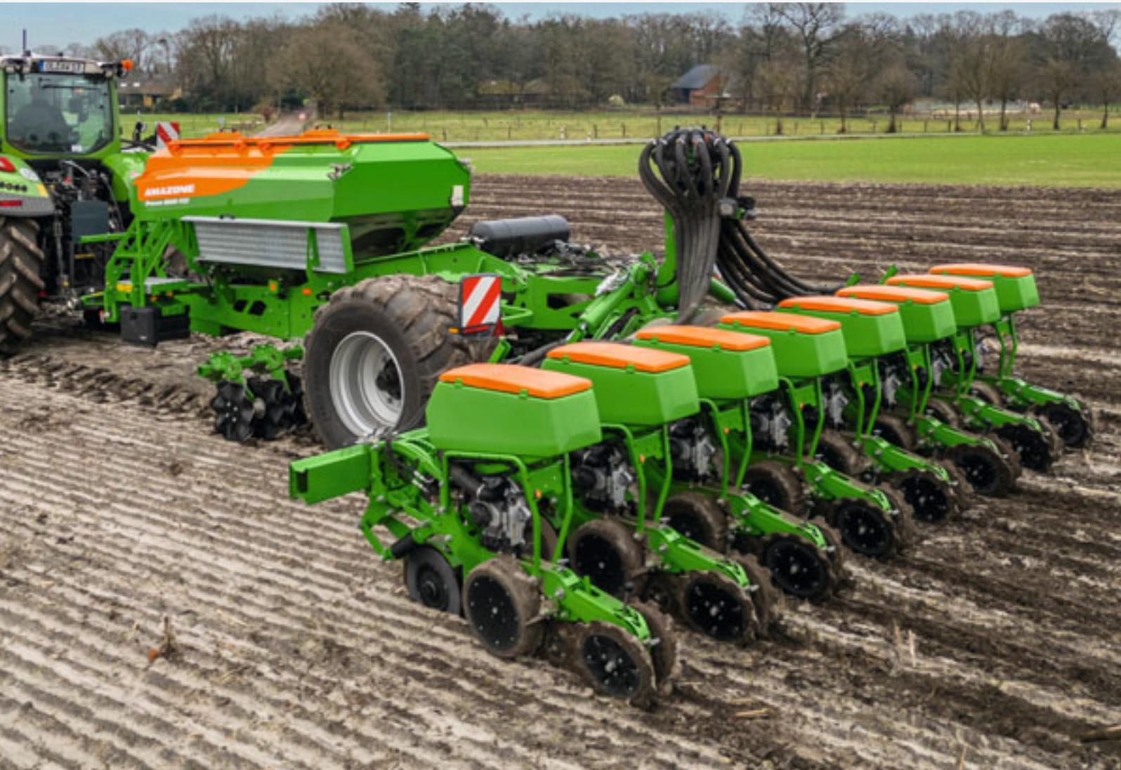
Les avantages du Precea 6000-TCC avec trémies de semences montées sur les éléments semeurs et trémie d'engrais centralisée :
