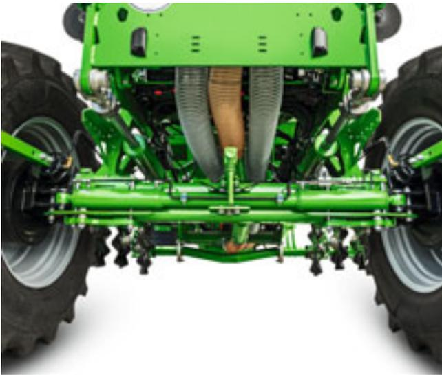
Vérin hydraulique de l'essieu télescopique
