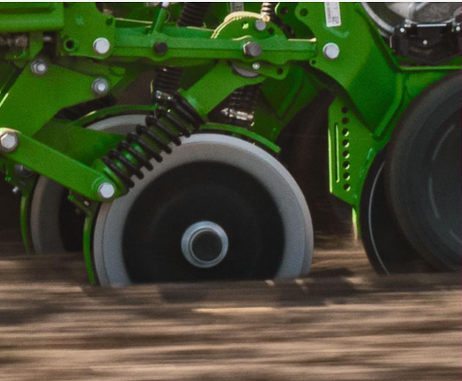
L'enfouisseur double disque performant FerTeC twin HD est idéal pour le semis après labour et le semis mulch.
