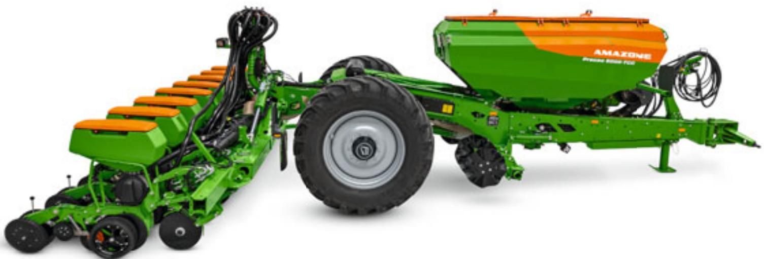
Precea 6000-TCC avec trémies indépendantes par élément et trémie d'engrais centralisée
