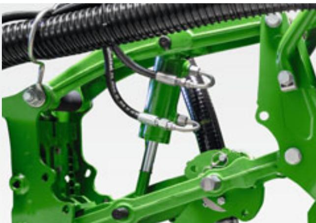
La pression de terrage est réglée très facilement hydrauliquement par le biais du vérin.
