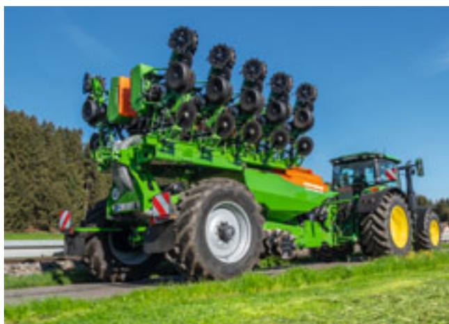
Le repliage des éléments semeurs est réalisé en quelques secondes – pour un déplacement routier en toute sécurité et un passage rapide d'un chantier à l'autre
