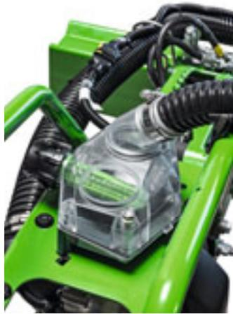
Trémie additionnelle au-dessus de l'élément semeur
