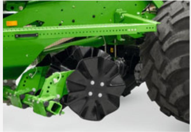
Réglage en hauteur mécanique de l'efface-traces roue à disque ondulé
