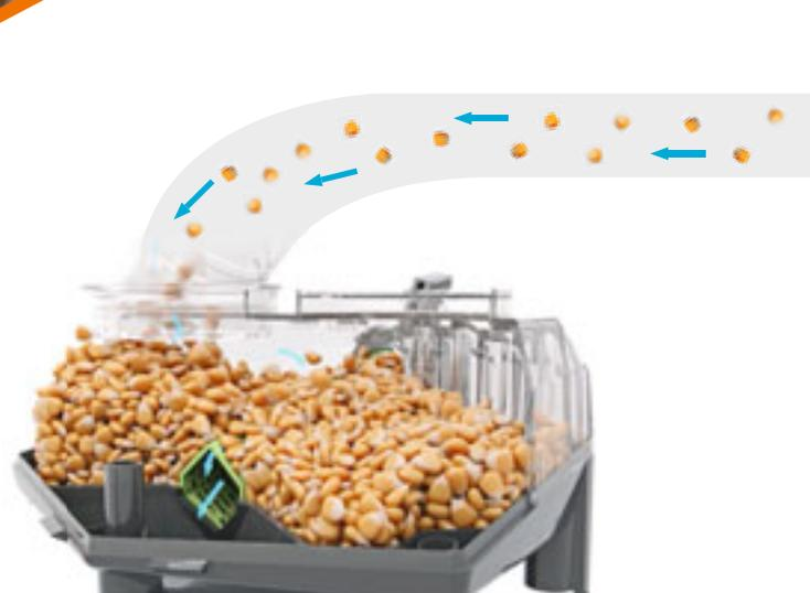
Illustration de la trémie additionnelle avec la trémie de semence pleine
