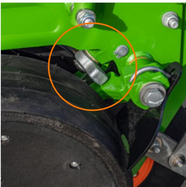
Sur des sols hétérogènes, l'axe de mesure enregistre les modifications au niveau de la force d'appui. Le système SmartForce piloté ISOBUS régule automatiquement ces variations. La profondeur d'implantation reste identique, quelles que soient les conditions de sol.
