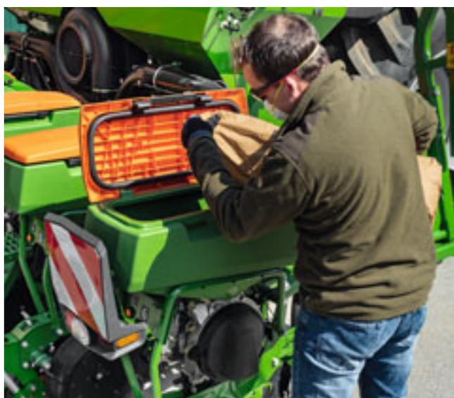
Les trémies de semence sont facilement accessibles et se manipulent d'une seule main pour l'ouverture et la fermeture.
