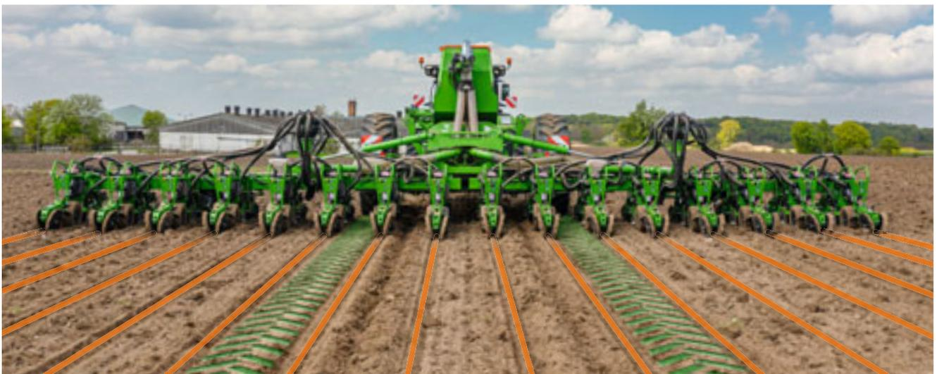
Les pneus de l'essieu Precea sont décalés entre les rangs de semis – pour respecter le sol
