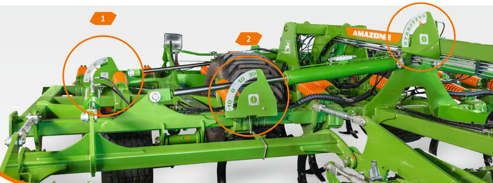
Гидравлическая настройка выравнивающего элемента
