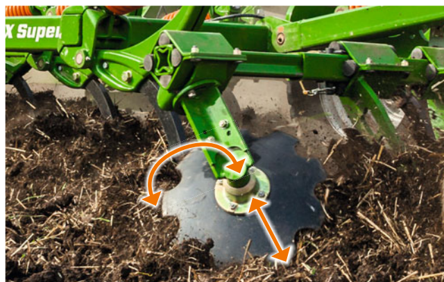
Крайний элемент – регулируется по высоте и наклону
