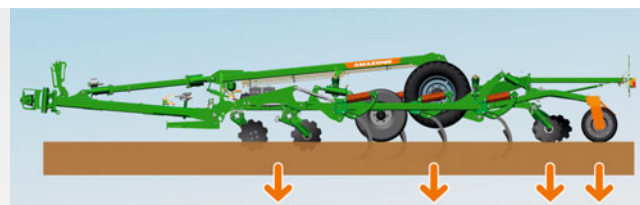
Ceus avec compartiment de disques et compartiment de dents en position de travail
