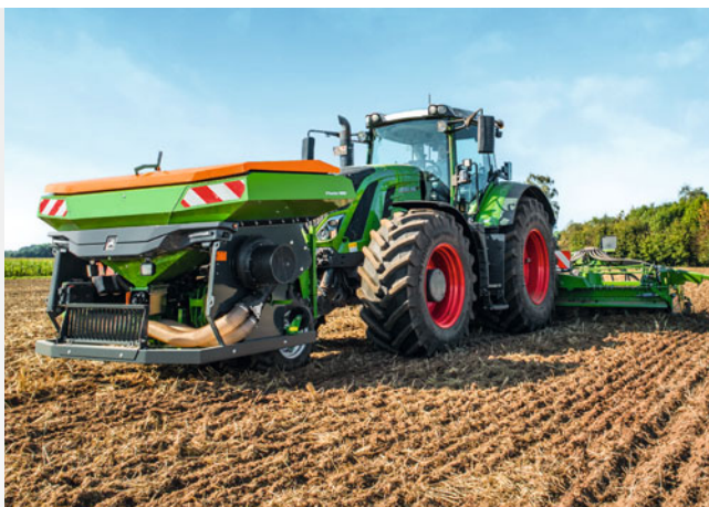
Trémie frontale FTender 1600 d'une capacité de 1 600 l
