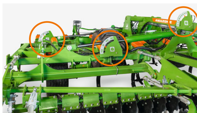
Affichages de la profondeur de travail des trois unités d'outils d'un seul coup d'œil
