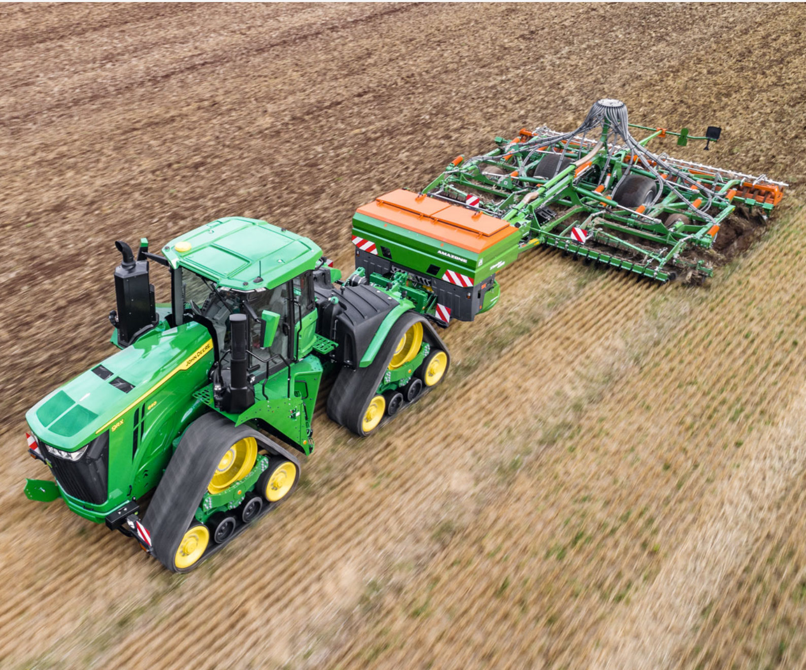
XTender 4200 mit 4200 l Behältervolumen
