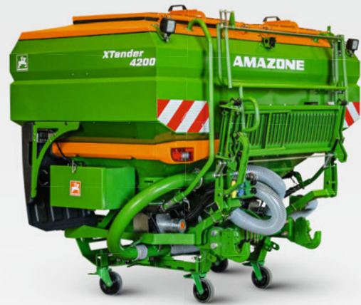
Anbaubehälter XTender 4200 mit Behältervolumen 4.200 l
