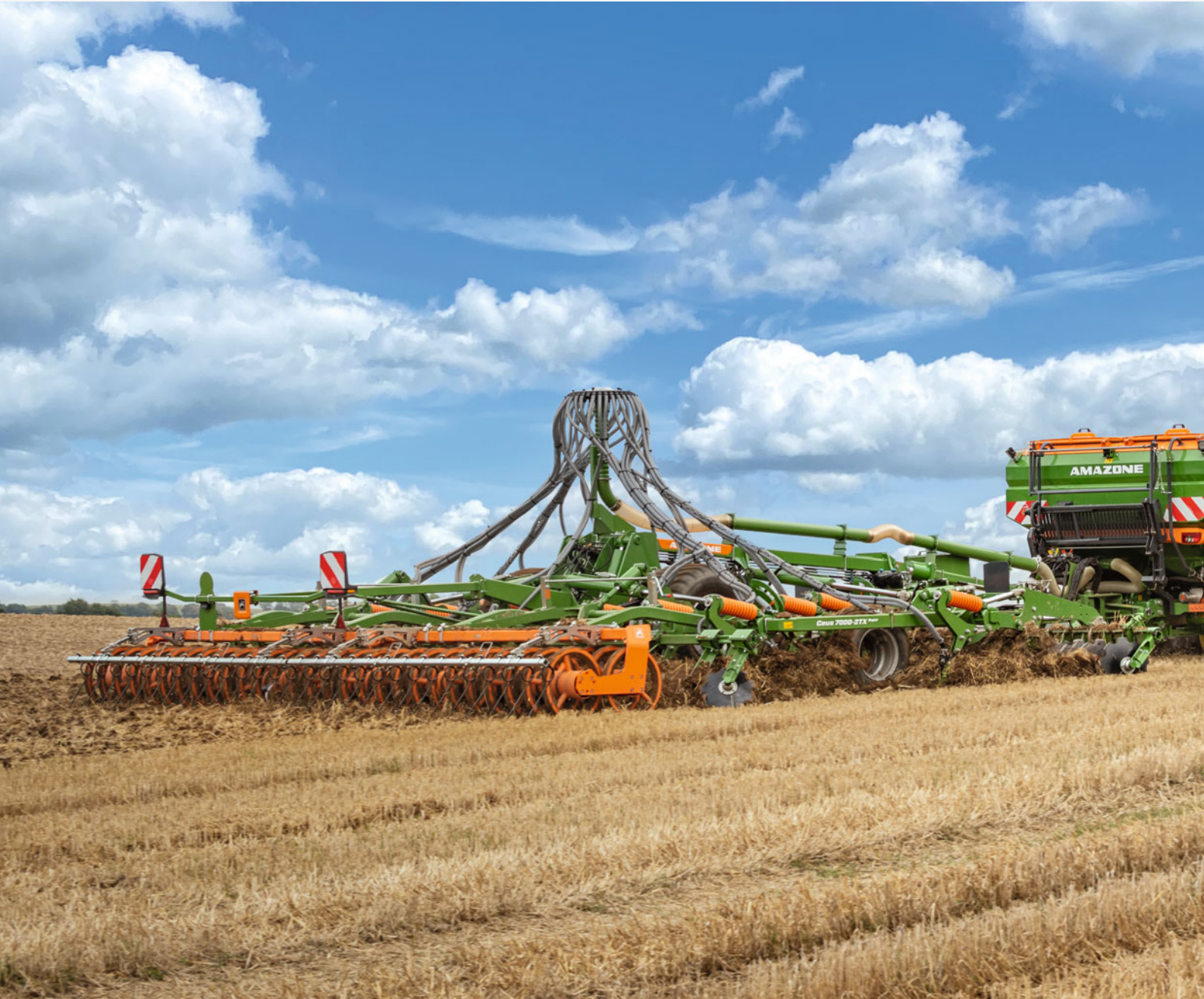
Ceus 7000-2TX Super kombiniert mit Heckbehälter XTender 4200 zur Zwischenfruchtsaat oder Düngung
