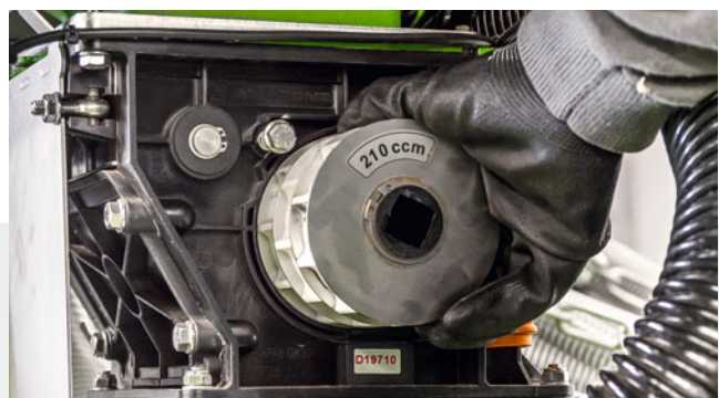
Einfacher Wechsel der Dosierwalze
