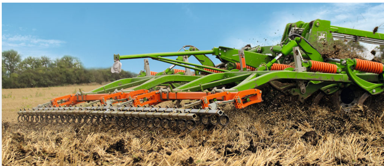
Doppelstriegel bei der flachen Bearbeitung
