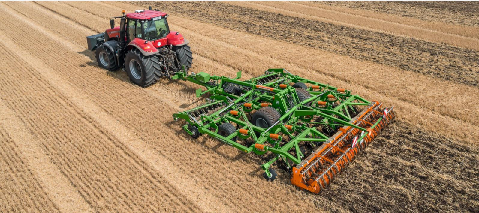
Die Ceus-2TX mit Arbeitsbreiten von 4 m bis 7 m ist für Betriebe mit großen Ackerflächen aber kurzen Einsatzfenstern. Durch die Kombination von Scheibenfeld und Zinkenfeld bietet die Ceus maximale Leistungsfähigkeit unter allen Bedingungen. In Abhängigkeit von der Arbeitsbreite benötigt die Ceus-2TX Traktoren ab 200 PS. Durch den geklappten Rahmen kann die Ceus zudem komfortabel und schnell auf der Straße gefahren werden.
