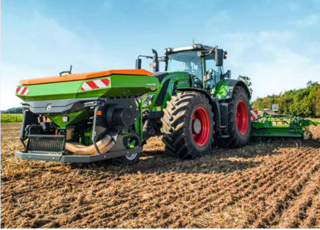
Frontanbaubehälter FTender 1600 mit Behältervolumen 1.600 l
