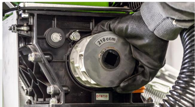
Einfacher Wechsel der Dosierwalze
