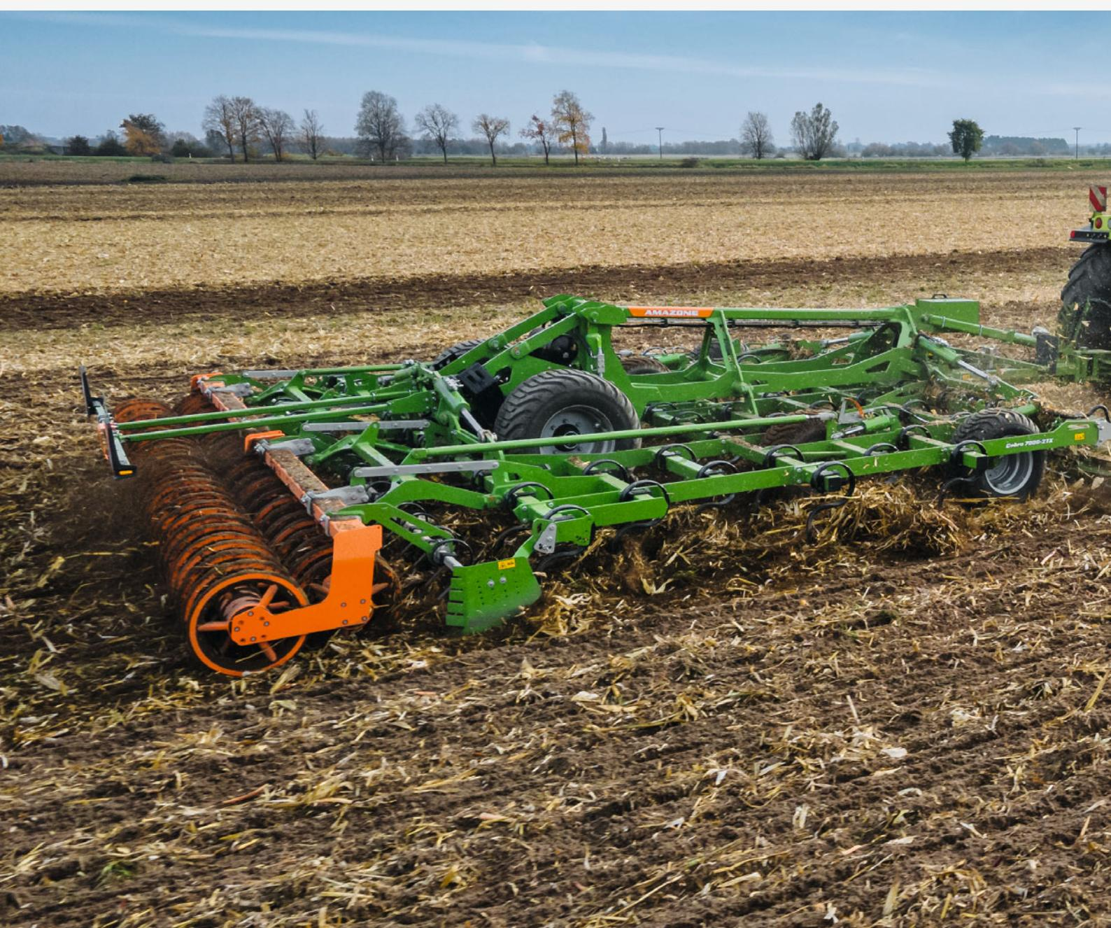
Le déchaumeur superficiel à 6 rangées de dents en largeurs de travail de 6 m et 7 m offre de nombreuses possibilités d'utilisation. De la destruction de couverts végétaux, en passant par le déchaumage superficiel, jusqu'à la préparation du lit de semis, le Cobra est un outil polyvalent par excellence pour la préparation superficielle du sol. Grâce à une gamme variée d'outils avant, de socs et de rouleaux, le Cobra s'adapte à tous les types de sols.
