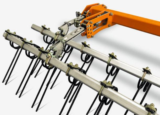
Le changement entre rouleau et herse double se fait aisément grâce au système de brides.
