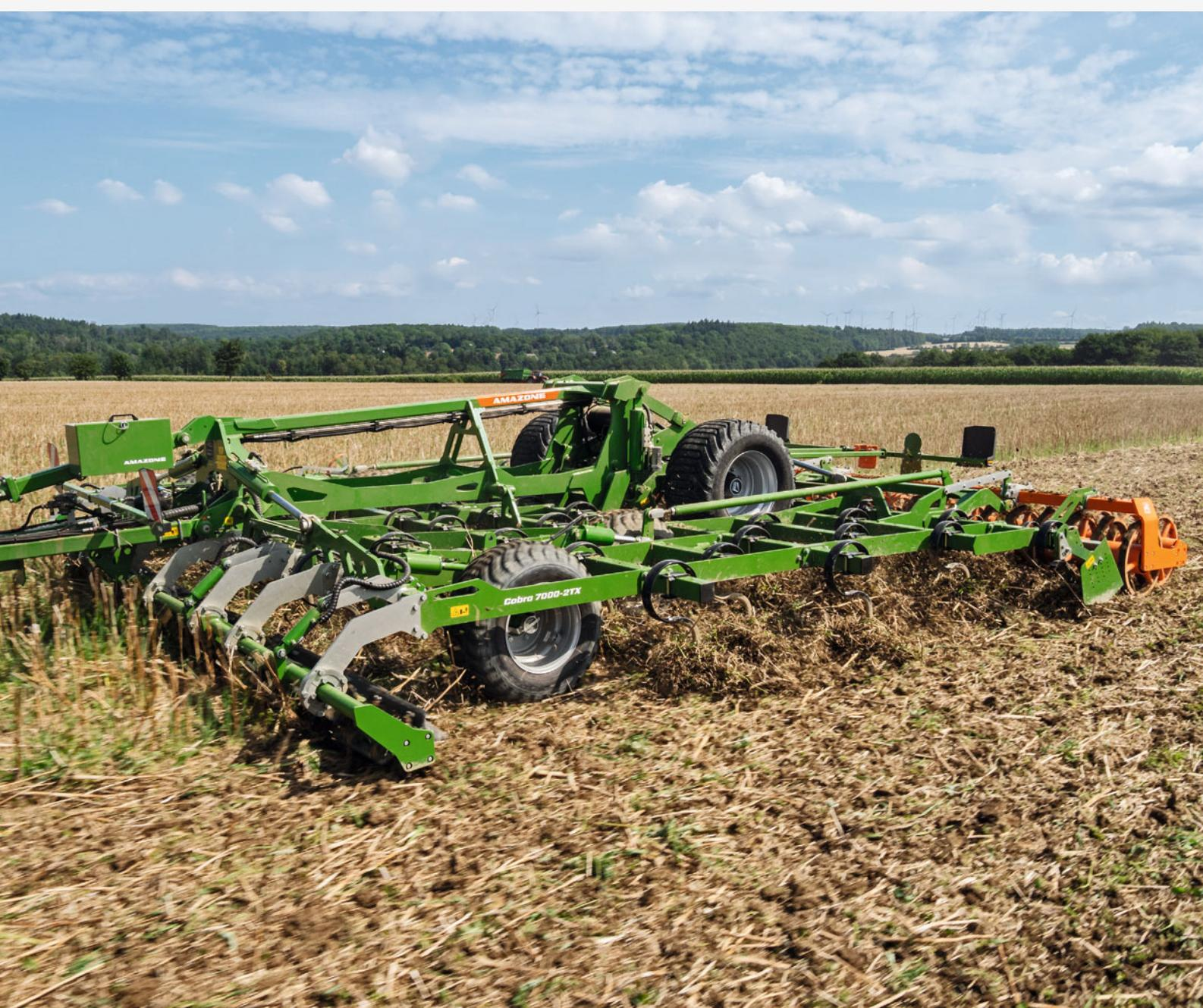
Cobra 7000-2TX avec rouleau hacheur
