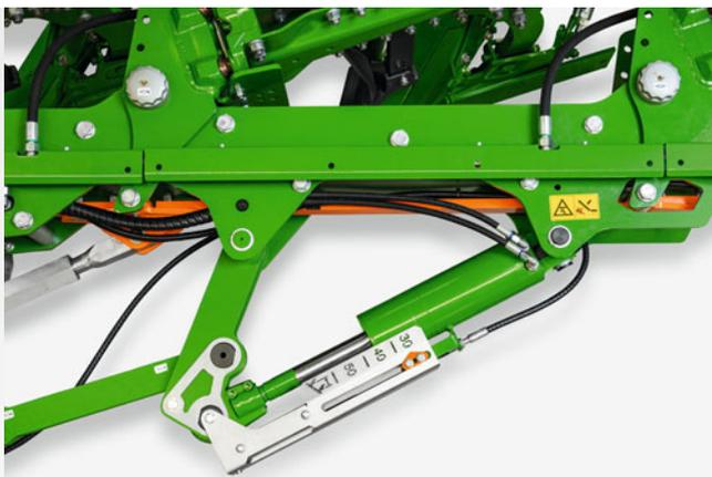
Гидравлическая регулировка ширины захвата
