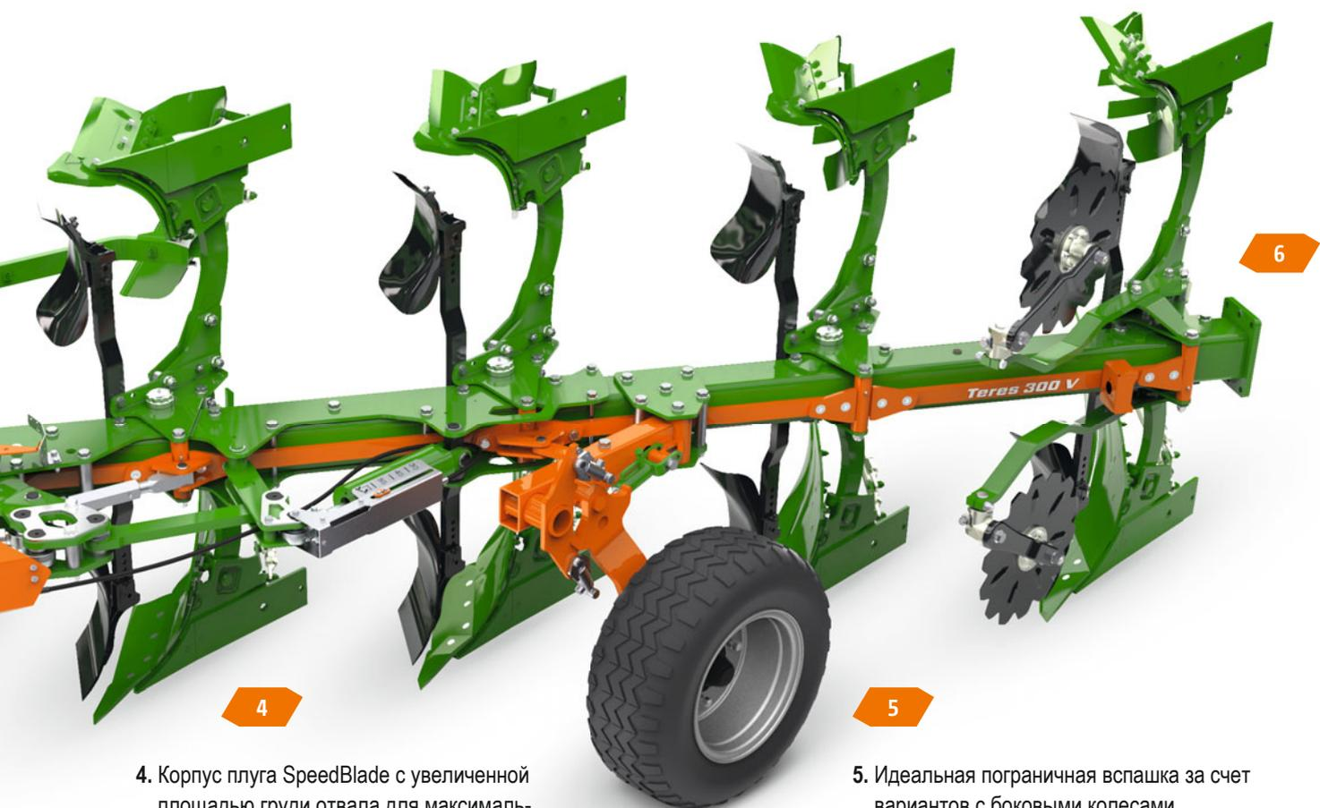
4. Корпус плуга SpeedBlade с увеличенной площадью груди отвала для максимальной скорости при минимальном износе
