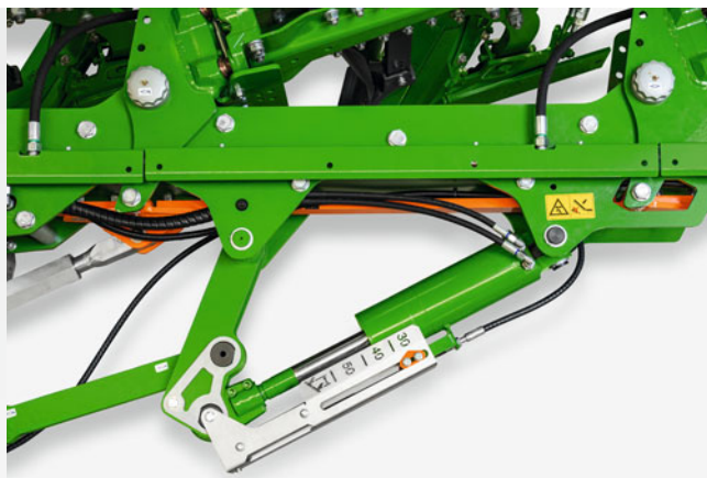
Hydrauliczna regulacja szerokości roboczej
