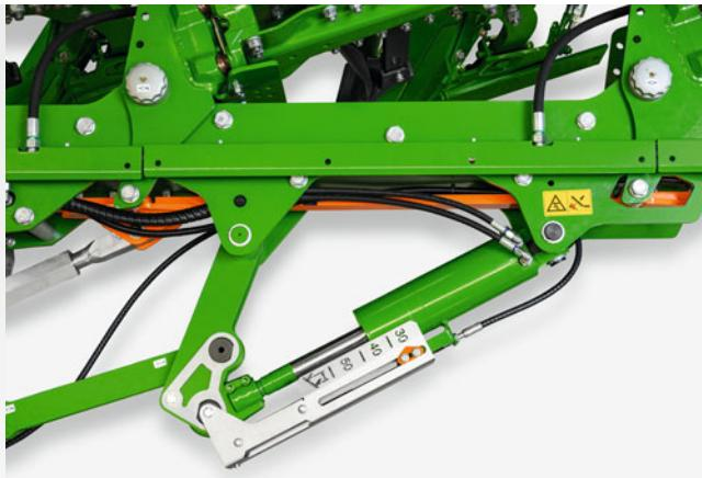
Réglage hydraulique de la largeur de travail
