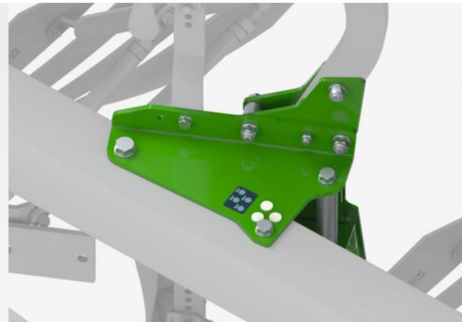
Réglage mécanique de la largeur de travail
