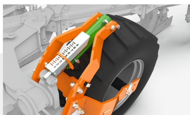
Réglage de profondeur de la roue
