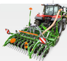
Посевная комбинация Avant 02 с фронтальным бункером
