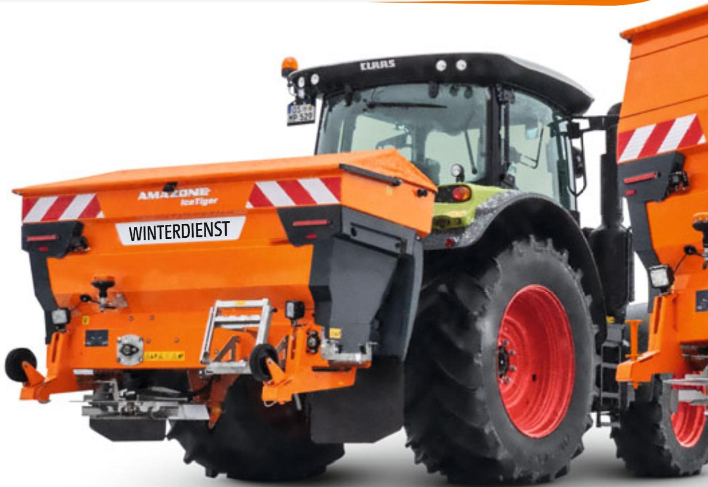
Für den langlebigen Einsatz im Winterdienst sind die wichtigsten Bauteile des IceTiger, wie z. B. die Präzisionsstreukscheibe, aus hochwertigem Edelstahl gefertigt. Um Korrosion durch aggressives Streugut zu verhindern, wird darüber hinaus eine spezielle Mehrlackierung für die übrigen Bauteile verwendet.
