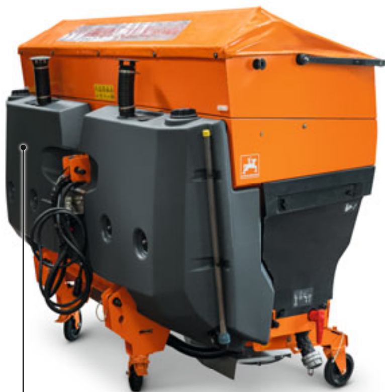
Feuchtsalzausstattung mit einer Tankkapazität von insgesamt 500 l für die Ausbringung von Feuchtsalz FS30
