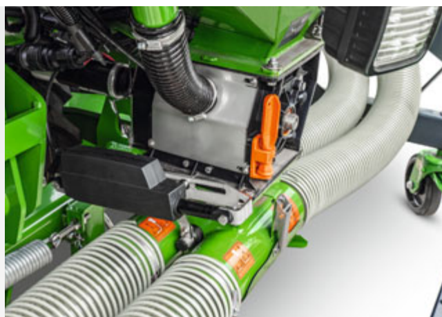
Elektryczne rozłączanie połówkowe dozownika w FTender
