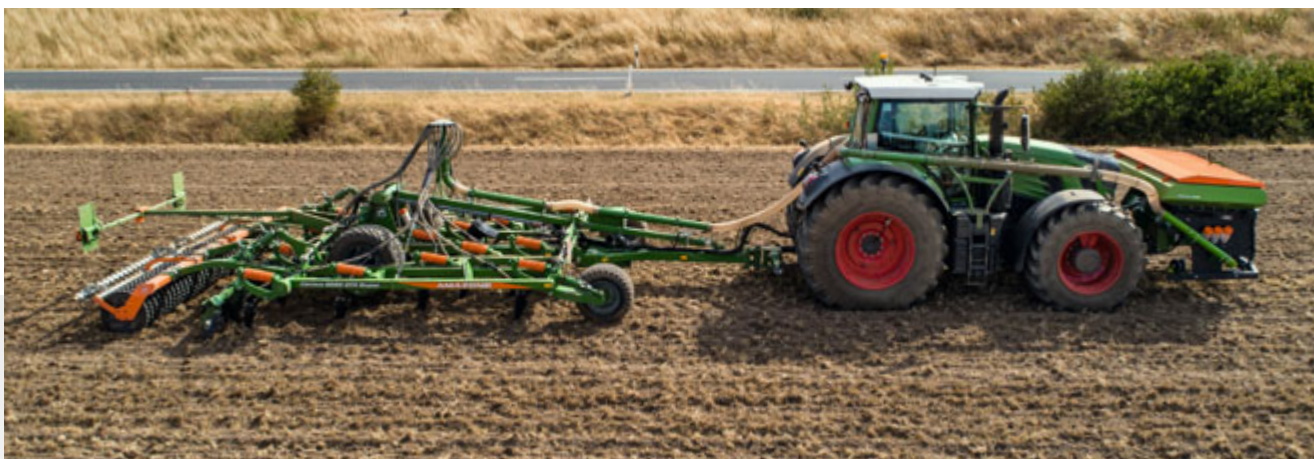
Przedni zbiornik FTender 1600 z kultywatorem zaczepianym Cenius-2TX
