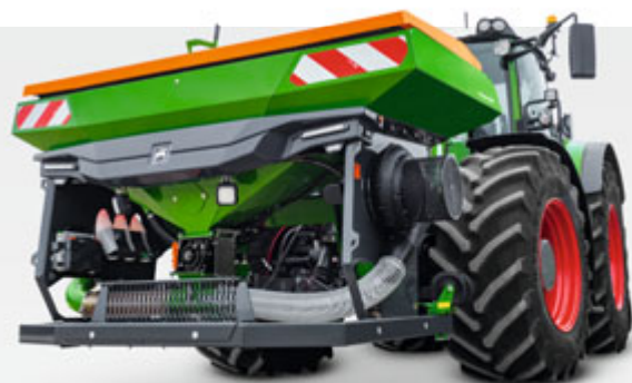
FTender 1600 z zamkniętym systemem transportowym w ciśnieniowej wersji zbiornika zapewnia szczególnie wysoką wydajność podawania
