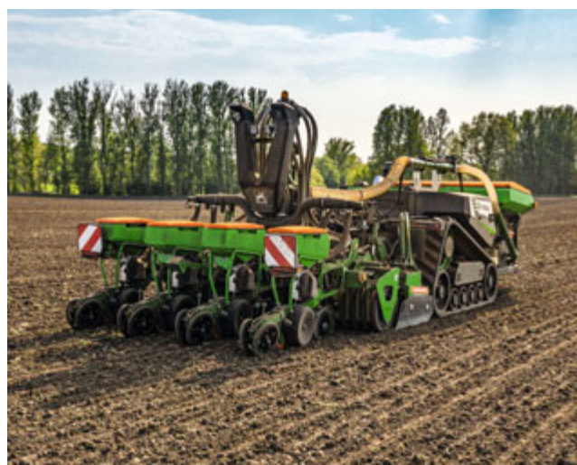
Precea 3000-AFCC z kultywatorem wirnikowym KG
