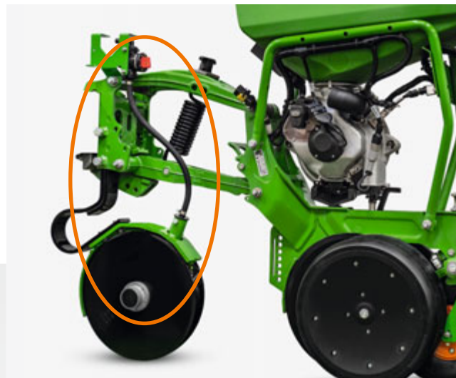
Zestaw do nawożenia płynnego na redlicy nawozowej FerTec Twin
