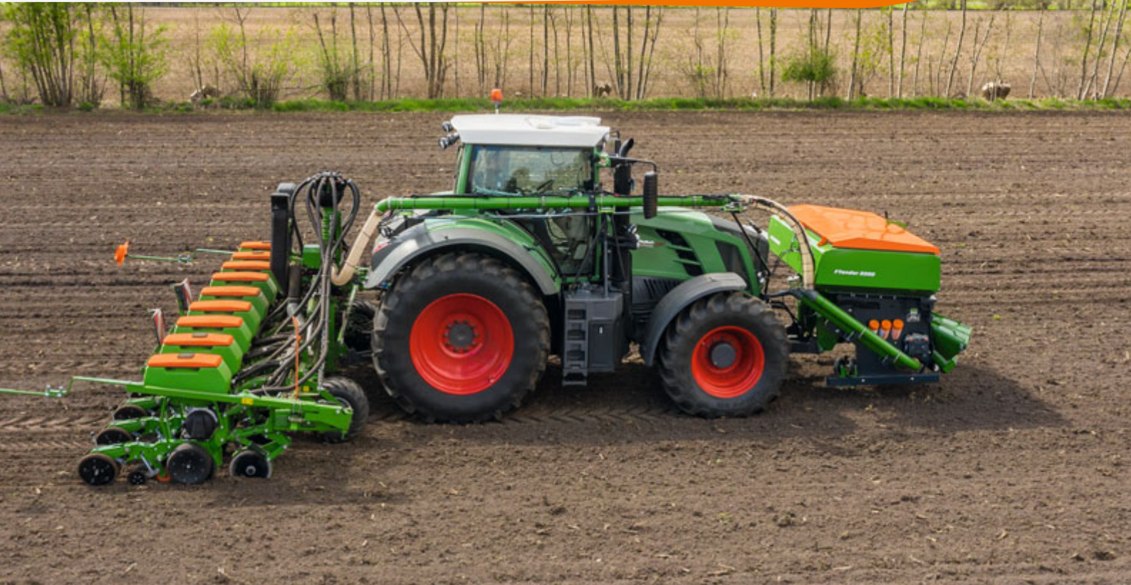
Przedni zbiornik FTender 2200 z siewnikiem punktowym Precea 6000-2FCC
