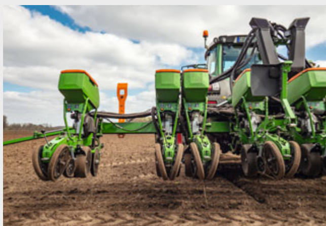
Duży rozstaw rzędów umożliwia utworzenie ścieżki technologicznej przy przesuniętej agregacie.
