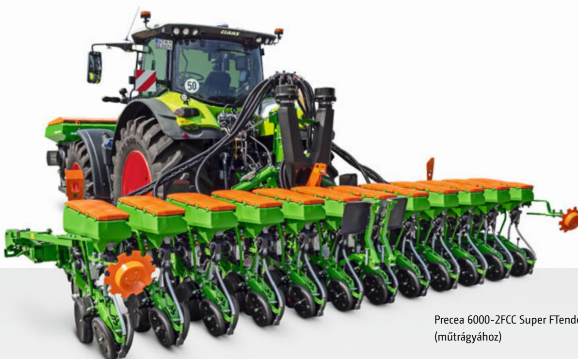
Precea 6000-2CC Super hátsó műtrágyatartály- lyal és feltöltőcsigával
