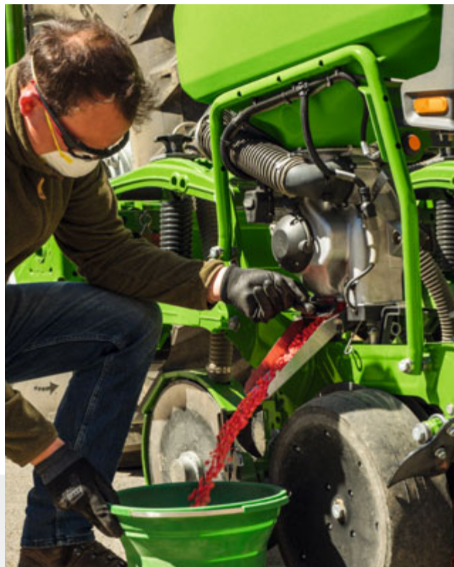
A visszamaradó mennyiségek leürítése gyorsan, egyszerűen és tiszta kézzel elvégezhető. Ráadásul mindkét oldalról.
