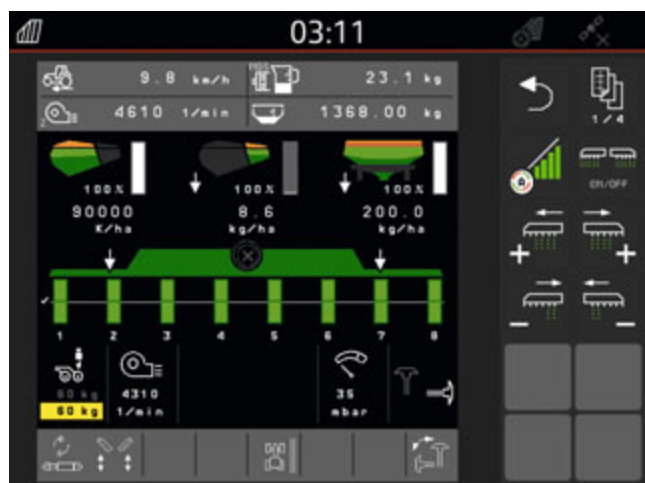
A mikrogranulátum-szóró átlátható integrálása a terminál munkamenüjébe
