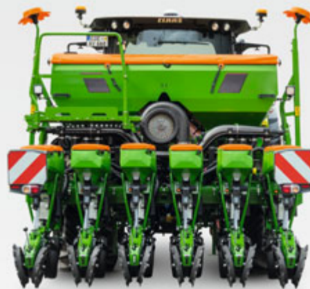
A Precea 4500-2CC vario teleszkópos vázzal, a legkisebb munkaszélesség mellett
