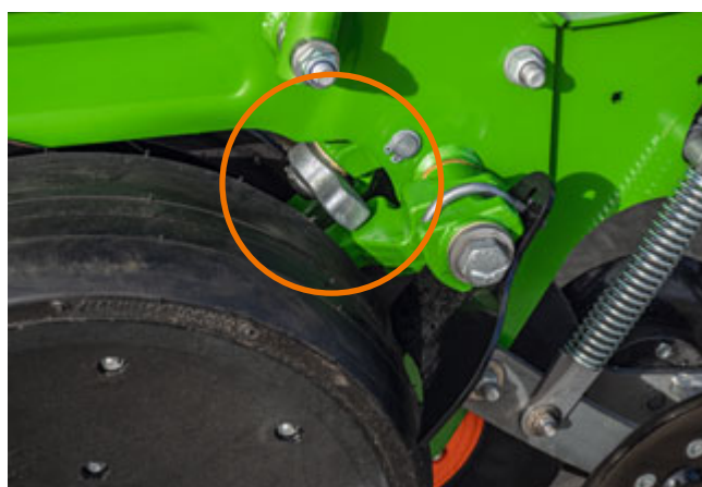
Változó talajviszonyok esetén a mérőcsap észleli az felfekvő erő változásait. Az ISOBUS-vezérelt SmartForce rendszer ezután automatikusan leköveti ezeket az ingadozásokat. A vetési mélység minden talajviszonyok között állandó marad.
