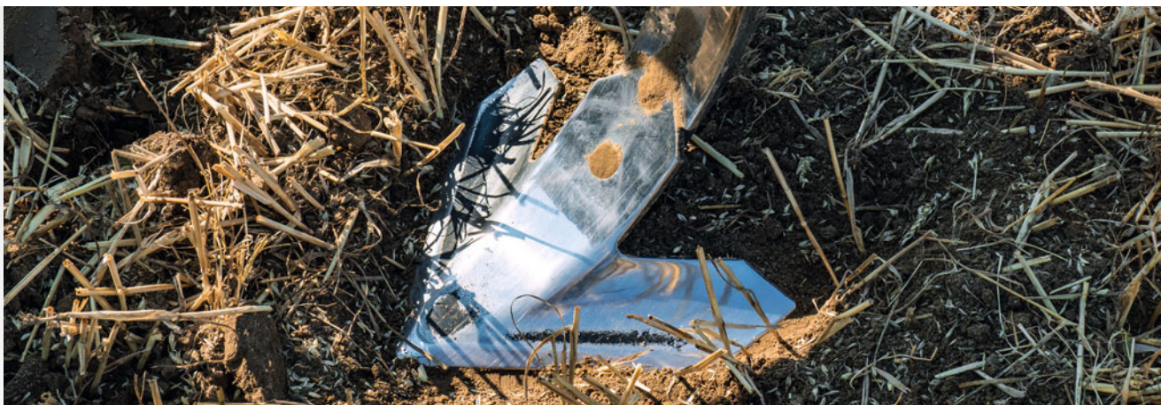
Gęsiostopka do minimalnej głębokości roboczej 3 cm
