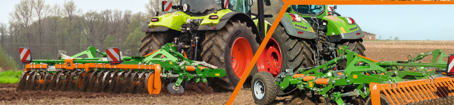
Cenio 4000-2 Super ze sprężynowym wałem pierścieniowym
