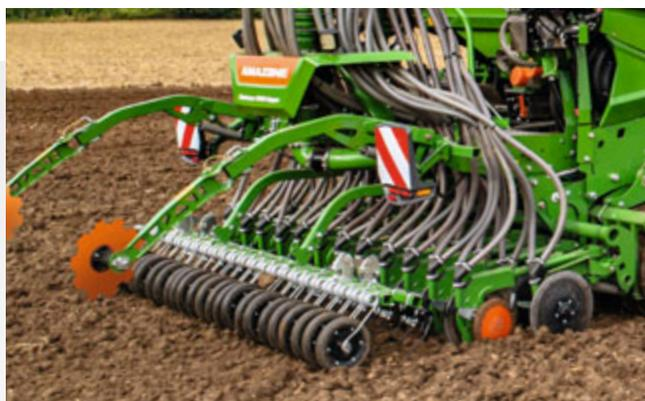
Давление на штригель настраивается механически за счет предварительного натяжения пружин штригеля. При гидравлическом изменении давления на штригель заранее устанавливается минимальное и максимальное значение путём вставки болта. Таким образом, во время движения можно быстро и просто адаптировать под переменные почвенные условия давление на штригель и сошник одновременно с помощью всего лишь одного гидророхода.
