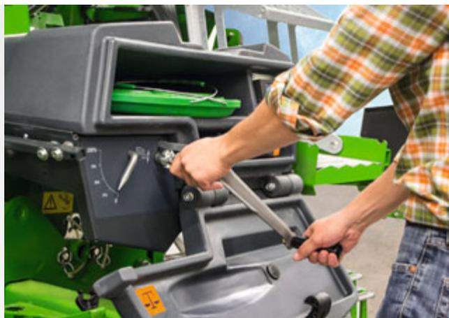
Централизованная настройка глубины укладки
