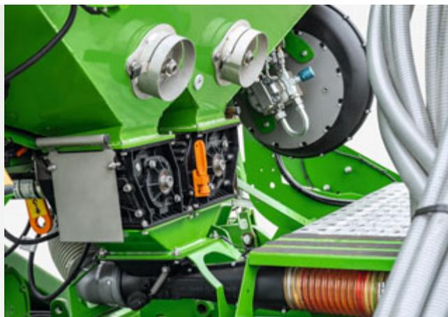
Два дозирующих устройства для различных вносимых материалов
