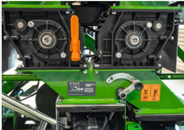
Два дозирующих устройства для различных вносимых материалов
