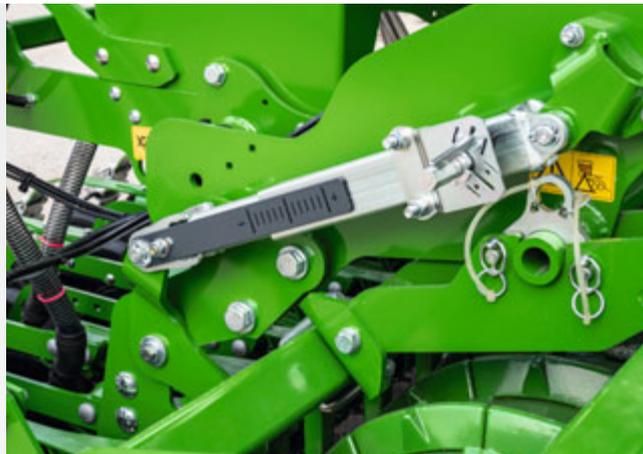
Простая настройка глубины укладки сбоку на машине
