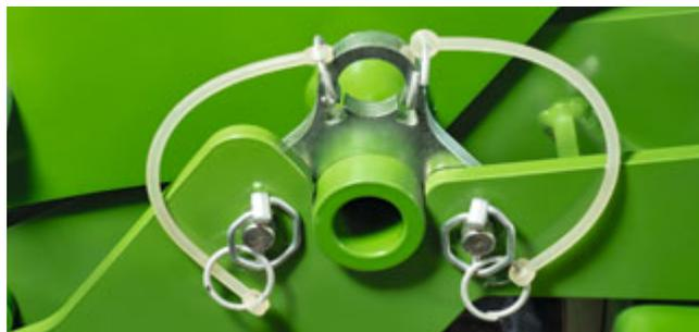
Три точки соединения с удобным доступом системы быстрой сцепки QuickLink способствуют безопасному и быстрому соединению и разъединению без использования инструментов.
