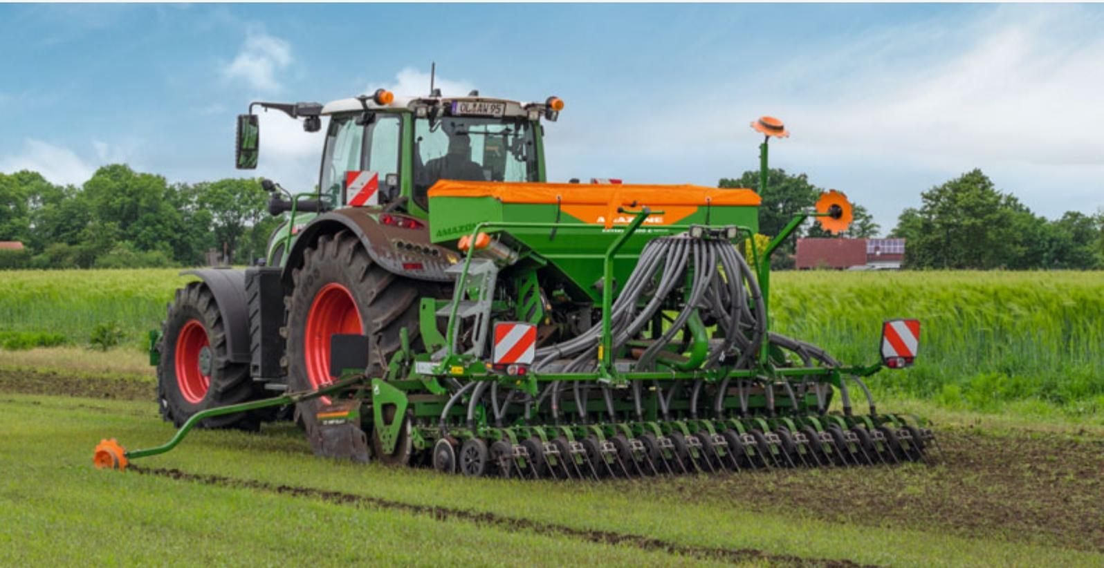
Разделенный бункер Centaya 4000-C Special позволяет одновременно вносить в почву два вида распределяемого материала по технологии Single-Shoot.
