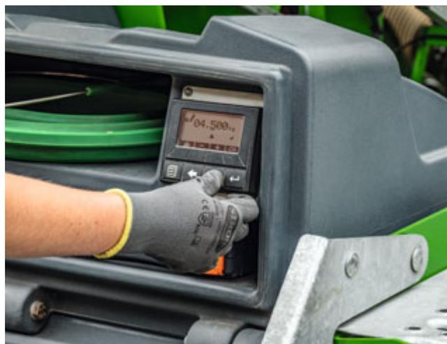
Опциональный терминал TwinTerminal 3.0 для ElectricDrive
