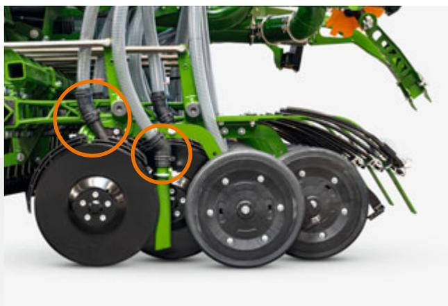
Сошник TwinTeC с дополнительным выходным отверстием
