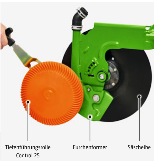
RoTeC pro-Schar (Ø 400 mm) mit Tiefenführungsrolle Control 25 Die rückwärtig geöffneten Lamellen sorgen für eine sehr gute Eigenreinigung.
