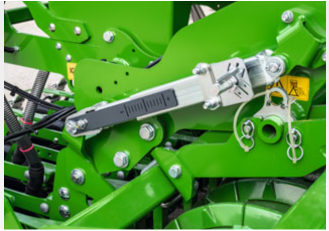
Einfache Einstellung der Ablagetiefe seitlich an der Maschine
