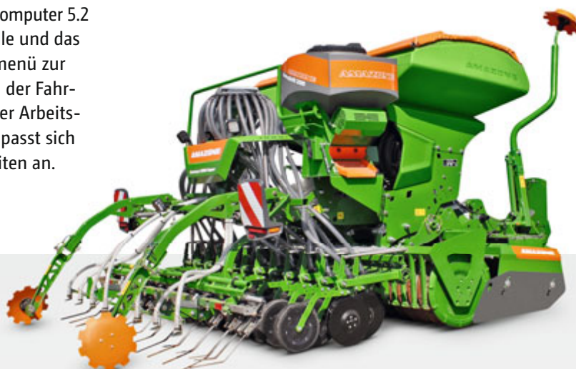
Ausbringung von Zwischenfrüchten und Untersaaten mit der Universal-Aufbausämaschine GreenDrill 200-E über Prallteller
