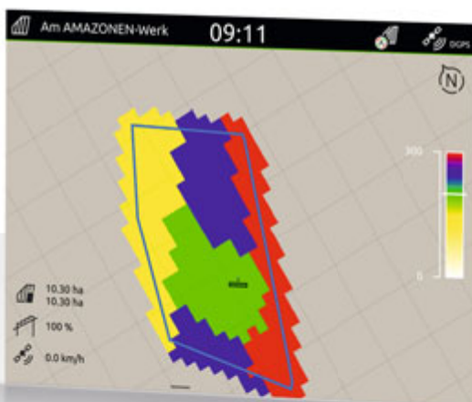
Darstellung der Applikationskarte im AmaTron 4
