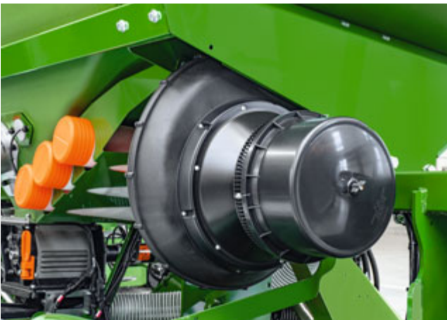
Der optionale Zyklonabscheider reduziert die Staubbelastung
