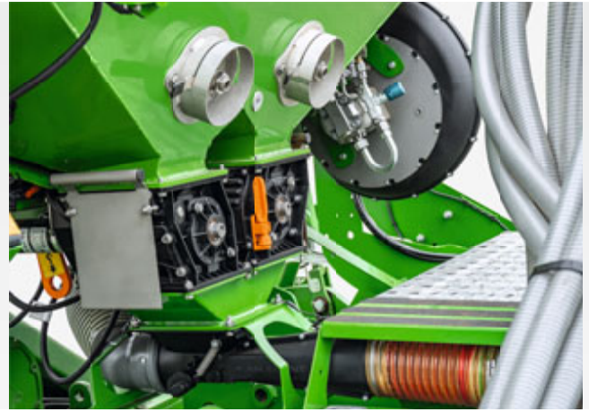
Zwei Dosierer für die verschiedensten Fördergüter
