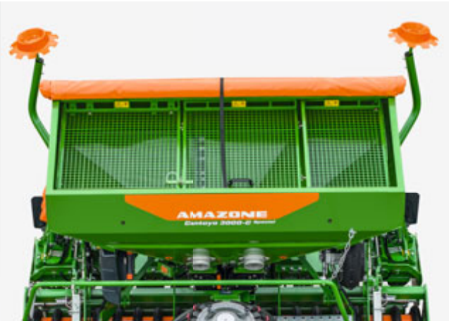
Centaya 4000-C Special mit Doppeltank im Verhältnis 70:30. So können zwei unterschiedliche Güter separat dosiert werden.
