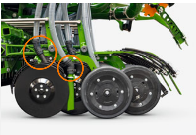
TwinTeC-Schar mit zusätzlichem Auslauf
