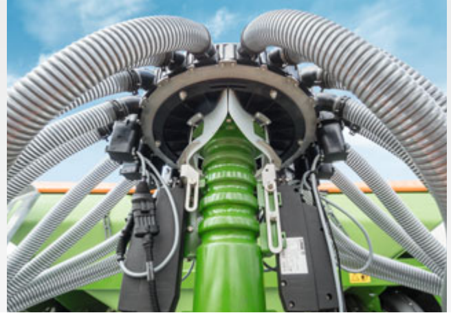
Segmentverteilerkopf mit elektrischer Halbseitenschaltung (nicht aktiviert)
