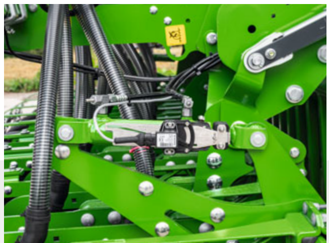
Zylinder für die hydraulische Schardruckverstellung
