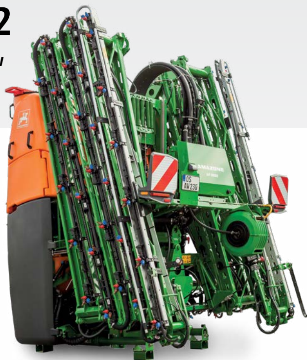
UF 2002 z belką polową Super-S2 o szerokości roboczej 30 m
