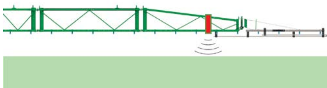
DistanceControl przy wyposażeniu w dwa czujniki: pomiar w łanie
