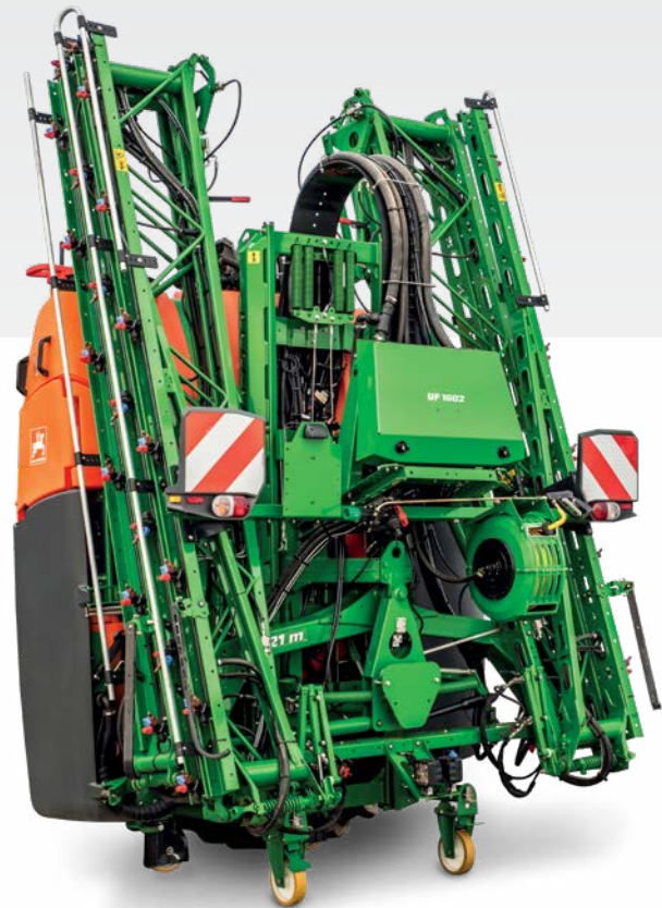
UF 1602 z belką polową Super-S1 o szerokości roboczej 21 m
