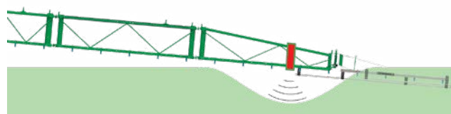
DistanceControl przy wyposażeniu w dwa czujniki: Belka polowa np. w przypadku wyległego zboża może zanurzyć się w łan
