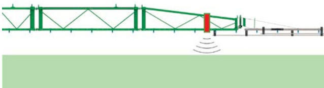
DistanceControl bei Ausrüstung mit zwei Sensoren: Messung im Bestand
