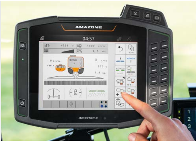
Activation de DirectInject sur le terminal AmaTron 4
