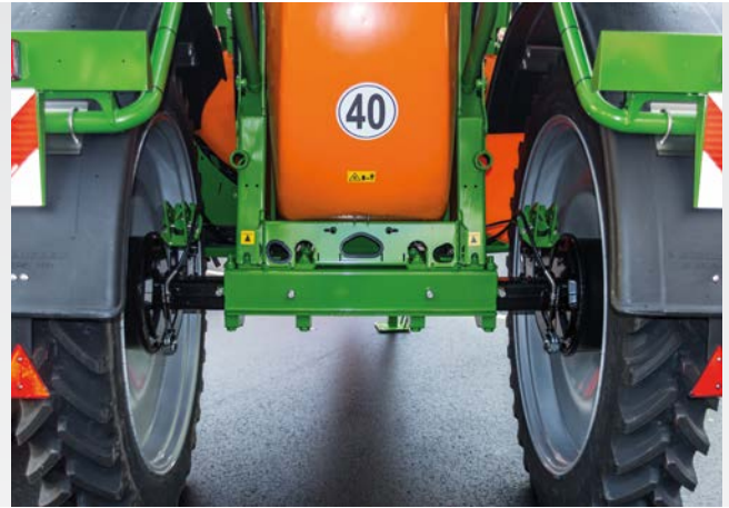
Essieu réglable avec réglage de la voie en continu de 1,50 m à 2,25 m pour l'UX 4201
