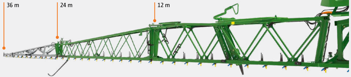
Rampe Super-L3, largeur de travail 36 m, réduction possible à 24 m et 12 m
