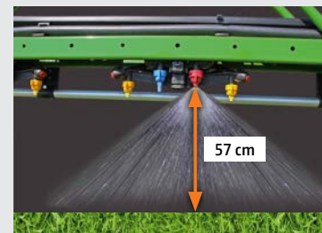
Buse 110° : Ecart entre buses 50 cm
