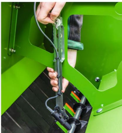
Простая перестановка с посева мелкосеменных культур на стандартный посев с помощью запорных заслонок
