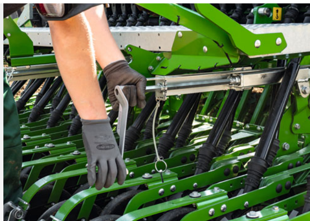
A vetési mélység lehető legegyszerűbb beállítása a Cataya Special hátsó részén jobbra és balra
