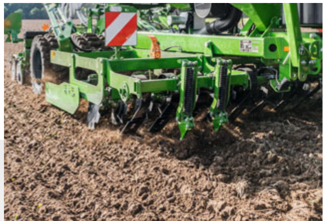
Połączenie włóki Crushboard i spulchniacza śladów ciągnika, zamontowane na ramie Cirrus
