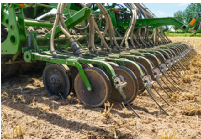
Redlica TwinTeC z hydrauliczną regulacją nacisku redlic
