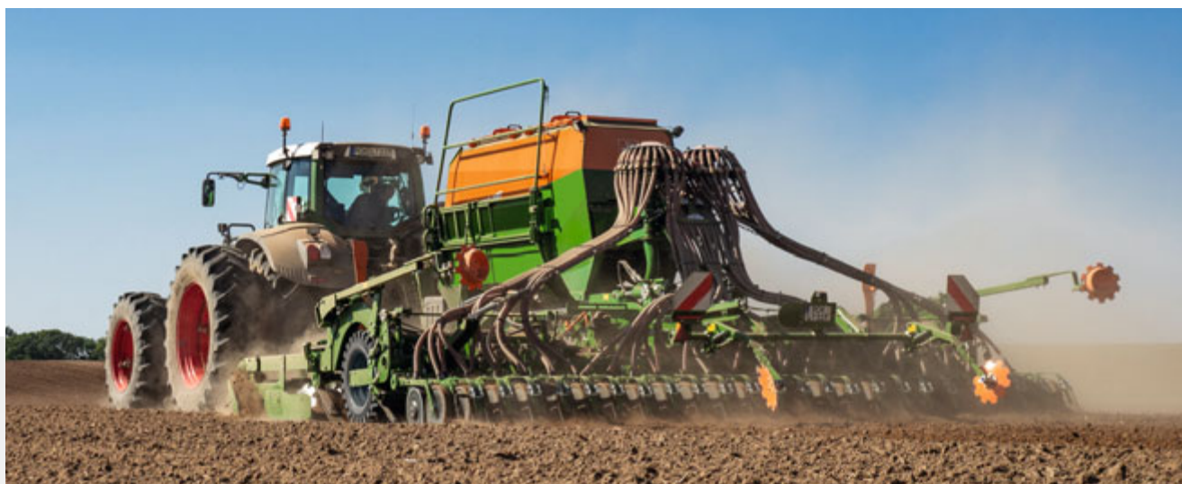
Zastosowanie wału nożowego dla wytworzenia odpowiednio drobnej struktury gleby przed siewem pszenicy
