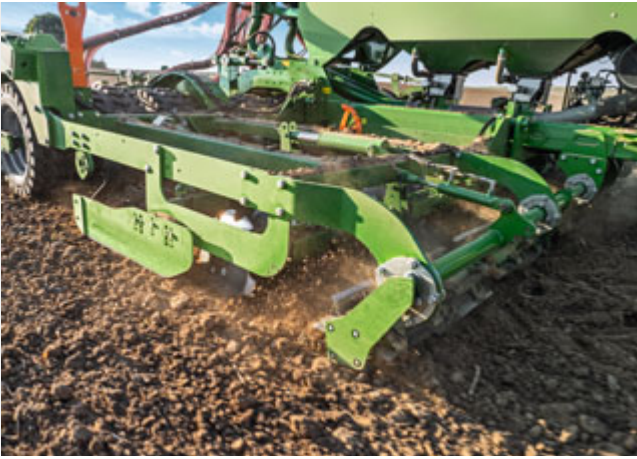
Die Messerwalze als aggressives Vorwerkzeug für die Cirrus 6003-2
