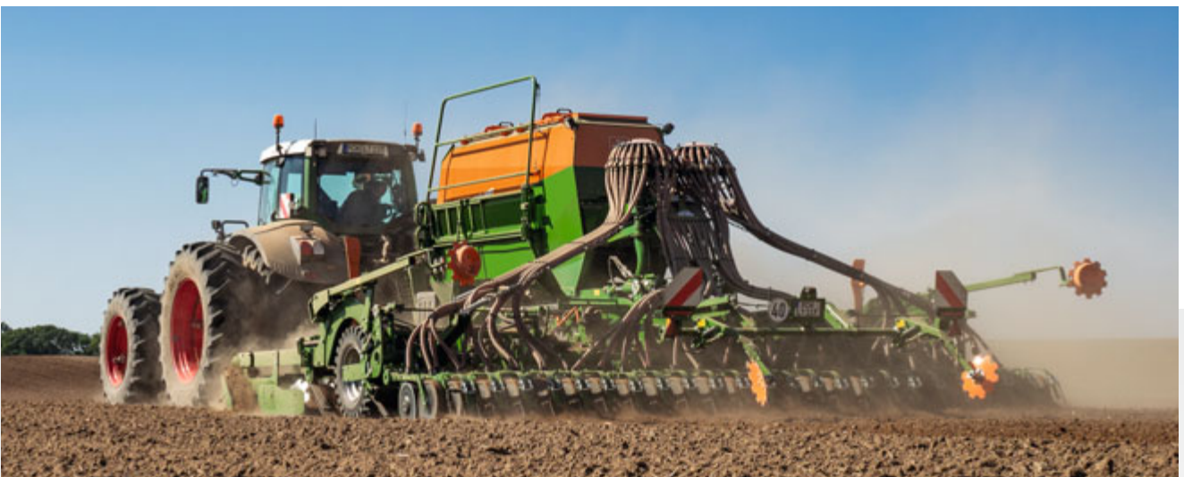
Einsatz der Messerwalze, um bei der Weizenfaat ein feinerdiges Saatbett herzustellen
