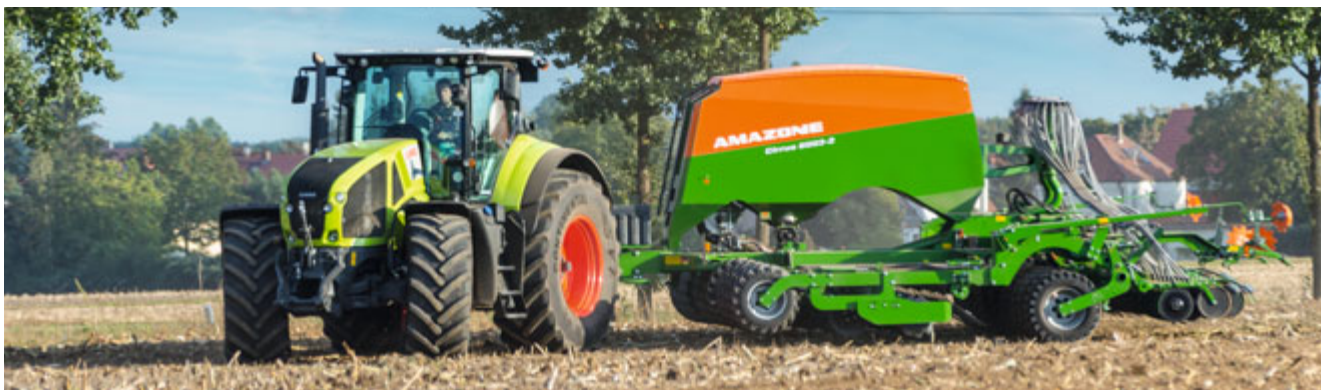
Die Cirrus 6003-2 mit einspitzigem Saatgutbehälter
