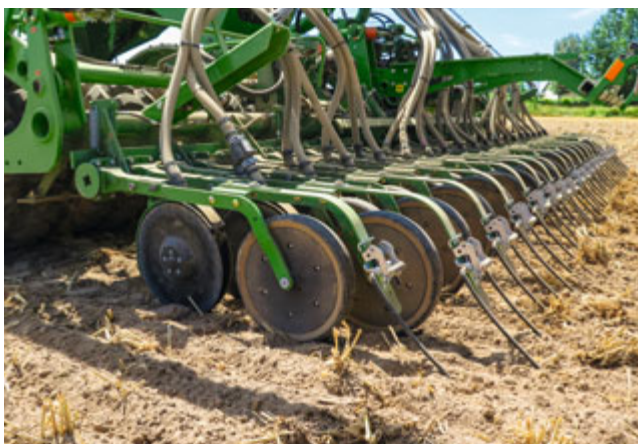
TwinTeC plus-Schar mit hydraulischer Schardruckregelung
