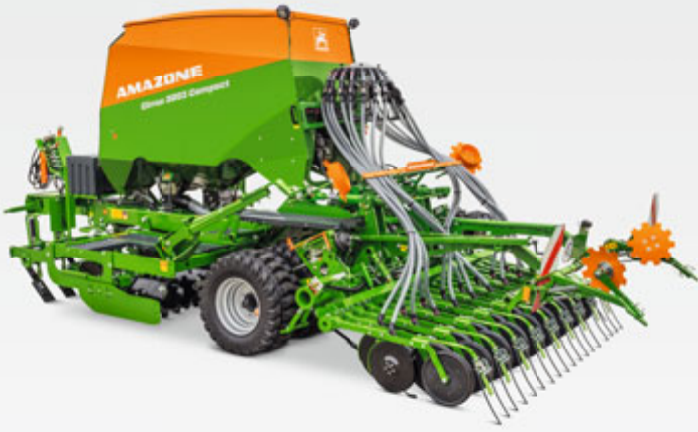
Cirrus 3003 Compact mit Doppelscheibenschar TwinTeC plus
