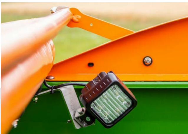
Oświetlenie wnętrza zbiornika
