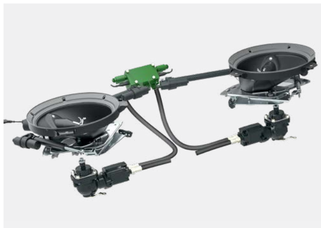
✔ ZA-TS-Hydro – hidraulikus szórótárcsa-hajtás
