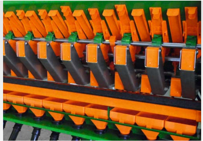
Dosierung von Düngung und Saatgut
