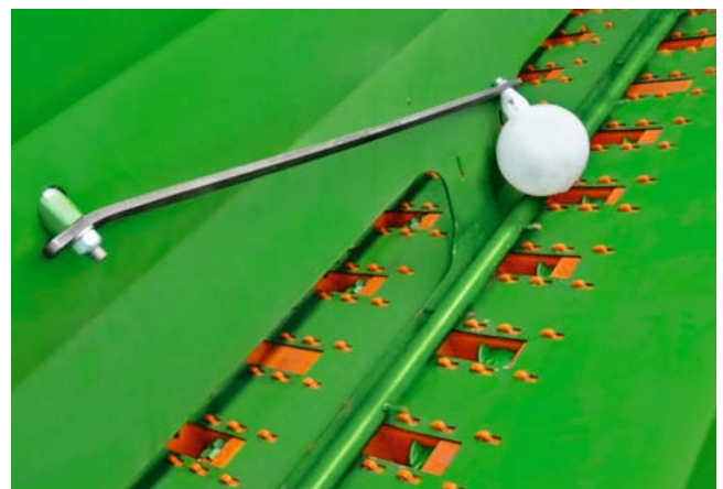
Durch Entfernen der Trennwände und Verschließen der Düngerdosierung kann das gesamte Behältervolumen für Saatgut genutzt werden
