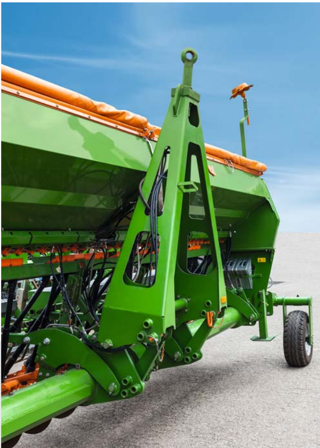
Hydraulisch klappbare Arbeitsdeichsel
