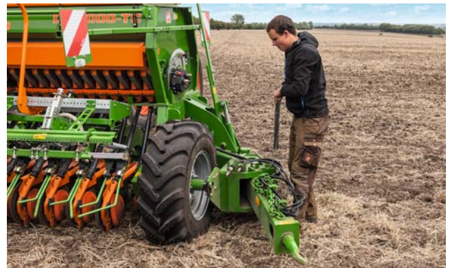
Längsfahrwerk mit klappbarer Transportdeichsel
