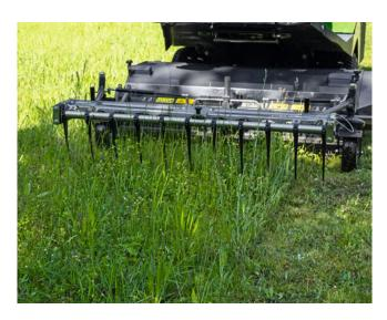
Система штригелей InsectGuard вызывает сильное вибрирование травы перед проходом косилочного механизма, отпугивая насекомых. Берегите природу с системой InsectGuard для Profihopper 1250 и 1500!
