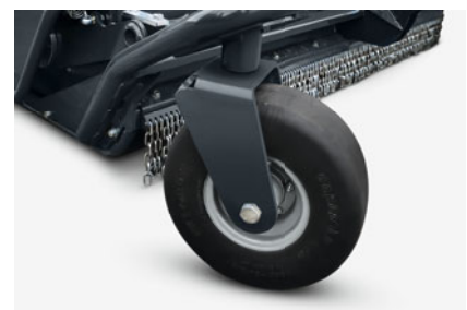
Die unplattbaren Reifen sorgen für mehr Einsatzsicherheit 2+3
