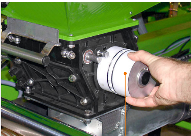
Замена дозирующих катушек осуществляется быстро на левой стороне машины
