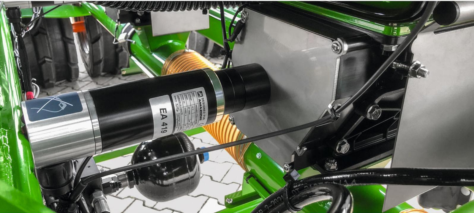
Präziser, elektrischer Dosierantrieb
