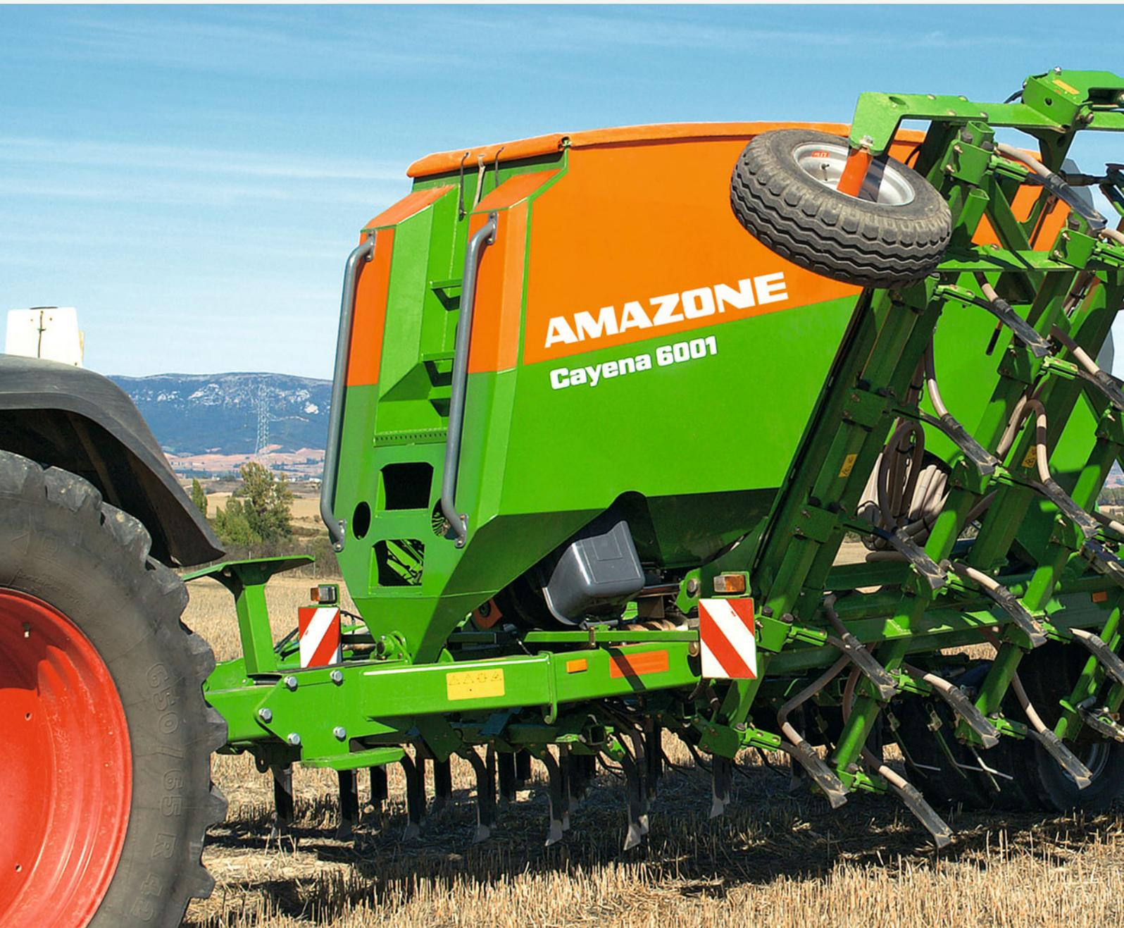
Die Zinkenschar-Anhängesämaschine Cayena ist konzipiert für die schnelle Saat auf harten, trockenen und steinigen Böden mit oder ohne vorherige Bodenbearbeitung.
