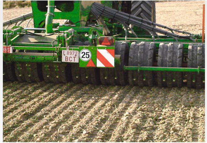
Keilringwalze mit Matrixreifenprofil
