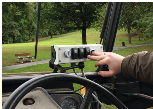
Электрогидравлическое управление позволяет осуществлять комфортное управление всеми гидравлическими функциями на моделях GHD, GHS и GHS Drive (специальное оснащение)
