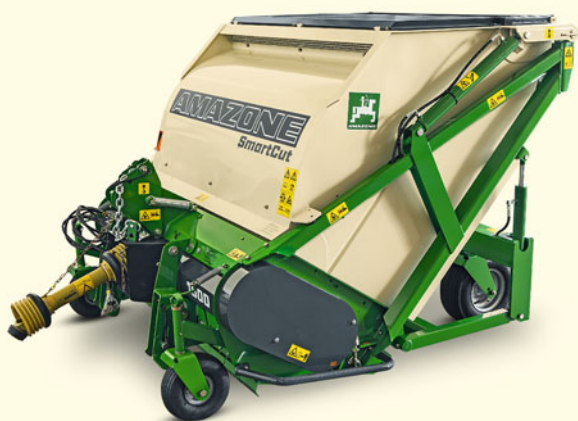
Газонокосилка Grasshopper SmartCut GHL-T 1500 с трехточечной навеской
