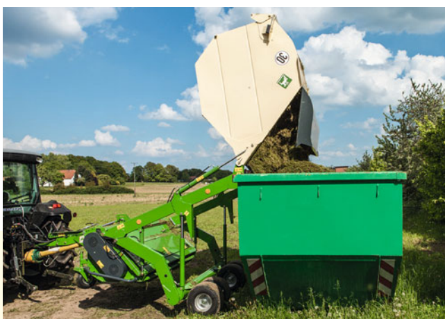
Возможна выгрузка бункера с высоты 2,3 м в более высокие прицепы или большие контейнеры
