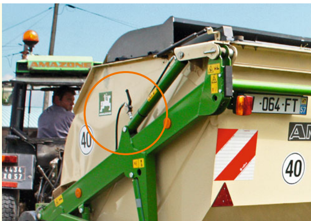
Гидравлический фиксатор для моделей газонокосилок Grasshopper с системой высотной выгрузки
