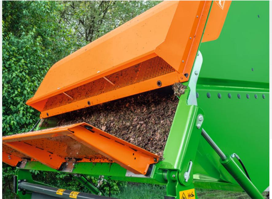
Durch den Luftstrom gelangt das Mähgut in den großen Sammelbehälter. Ein Steinschutzblech im Inneren des Behälters schützt die vordere Seite der Haube vor Steinschlag. So werden Schäden an der Maschine verhindert.
