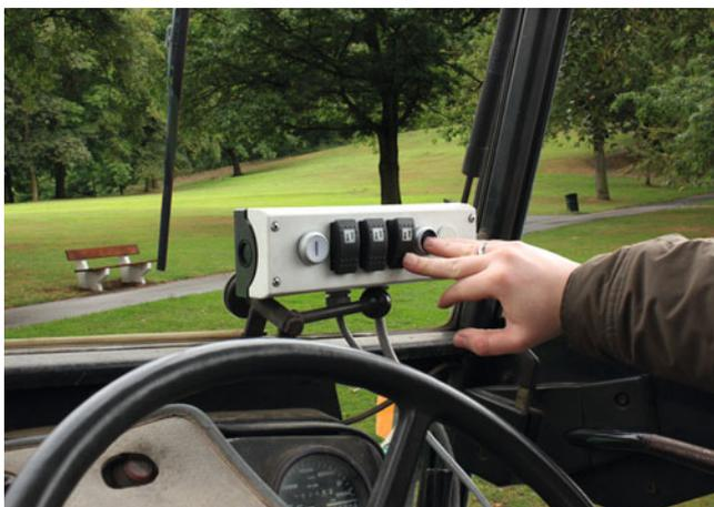
Eine komfortable Bedienung aller Hydraulikfunktionen erlaubt die Elektrohydrosteuerung bei den Produkttypen von GH-LT, GH-S und GH-S Drive (Sonderausstattung).
