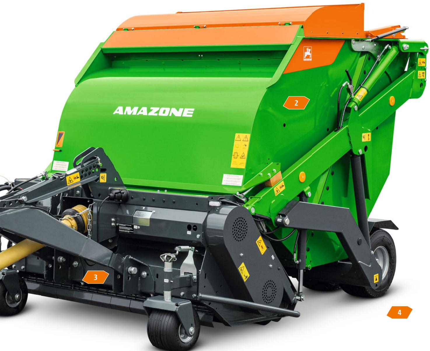
3. Feinschlegelmäher mit SmartCut-Exaktschnittrotor für geräuscharmes Mähen
