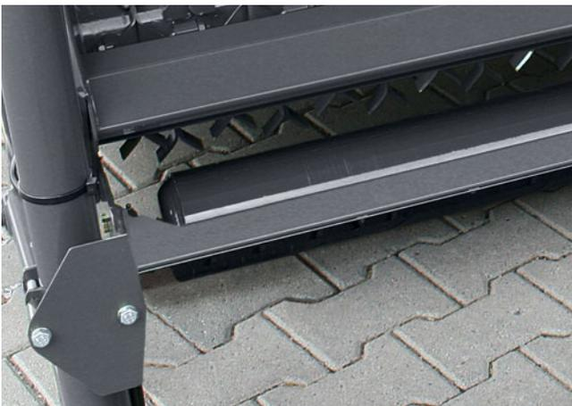
Mit der Stützrolle wird eine gleichmäßige Schnitthöhe und eine gute Bodenführung des Mähwerks erzielt. Das Walzen mit der Stützrolle trägt zur Widerstandsfähigkeit des Rasens bei
