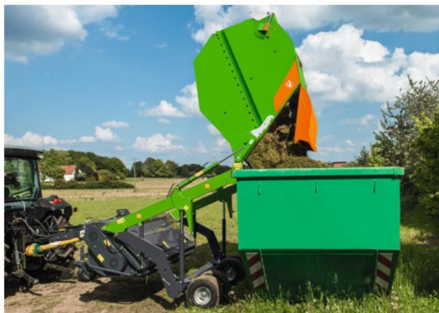
Das Entleeren des Behälters in höhere Anhänger oder in größere Container ist bis zu einer Höhe von 2,3 m möglich
