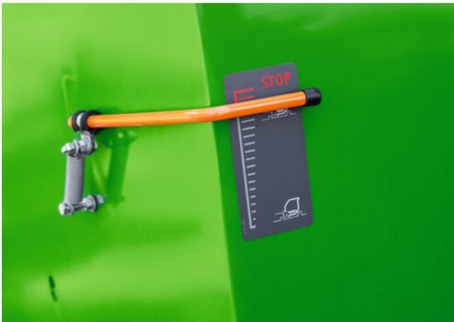
Die Füllstandsanzeige für den Fangkorb zeigt den Füllstand mit höherer Genauigkeit und Zuverlässigkeit an
