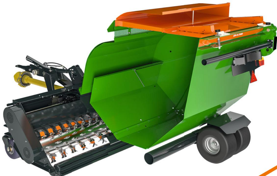
Optional kann ein Verschleißblech im Mähwerkrahmen verbaut werden, das die hohen Beanspruchungen unter sehr aggressiven Arbeitsbedingungen wie Vertikutieren in sandigem Gelände ausgleicht
