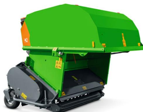
Einfache Bodenentleerung des GH
