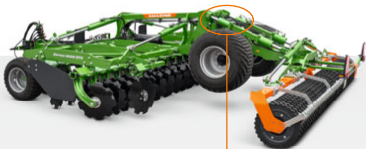
Гидравлическая верхняя тяга на Certos 6002-2TX
