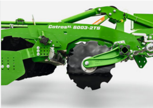
Catros XL 6003-2TS a legkisebb beállított tárcsamélységgel A tárcsák teljesen fel vannak hajtva a vázhoz
