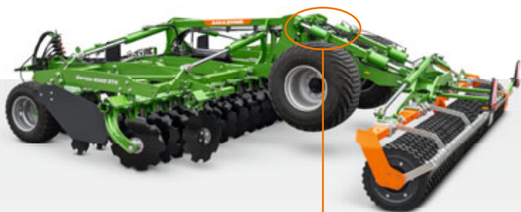
Barre supérieure hydraulique sur le Certos 6002-2TX
