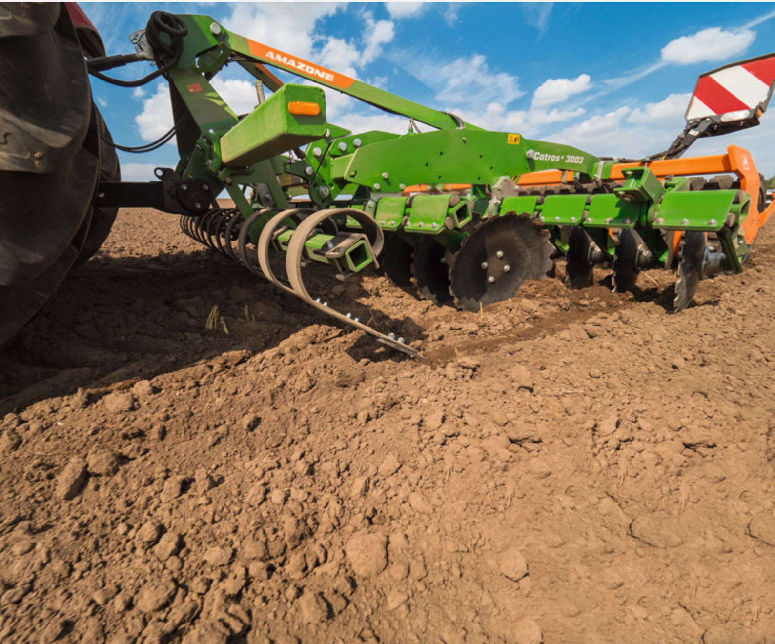
Catros+ 3003 avec Crushboard au travail
