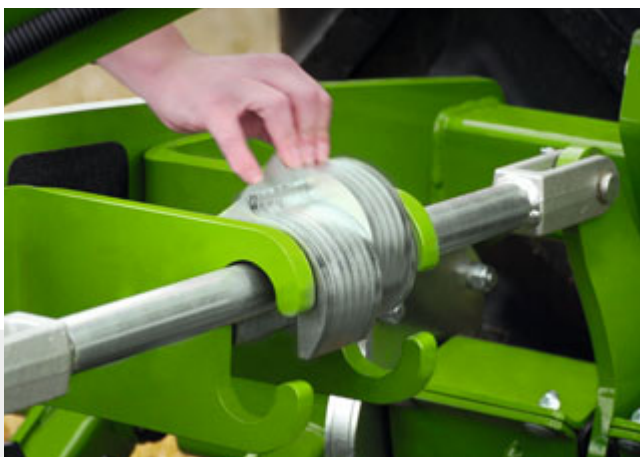
Munkamélység-beállítás távtartó elemekkel – itt sekély munkamélységhez
