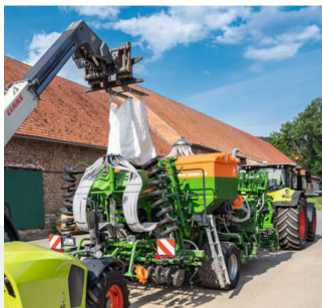
Быстрое и простое заполнение из биг-бэгов
