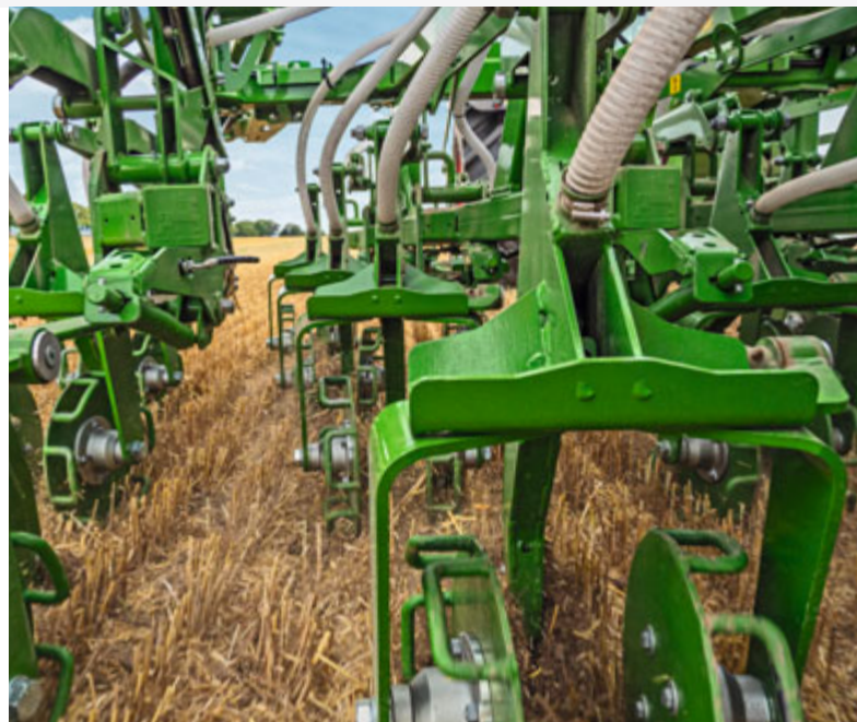
Принцип наклонного сквозного «тоннеля»
