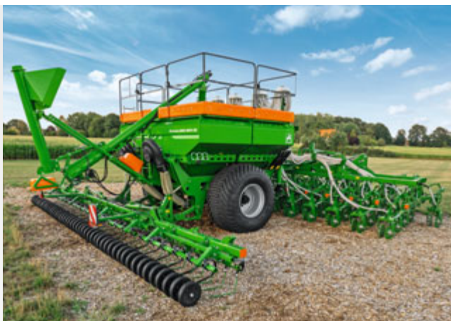
Primera DMC 9001-2C с загрузочным шнеком
