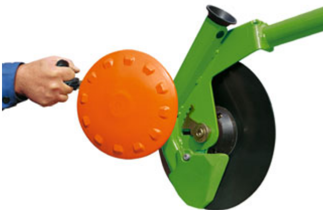
Redlica RoTeC (Ø 320 mm) z tarczą ograniczającą głębokość Control 10
