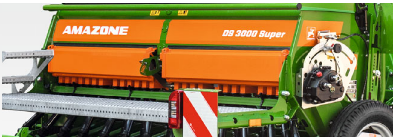
Zbiornik ziarna D9 z bezstopniową przekładnią Vario
