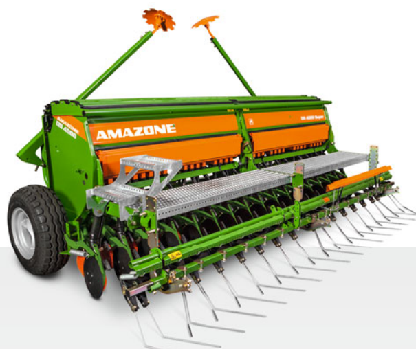
D9 4000 Super 4 m-es munkaszélességgel és RoTeC egytárcsás csorozlyával
