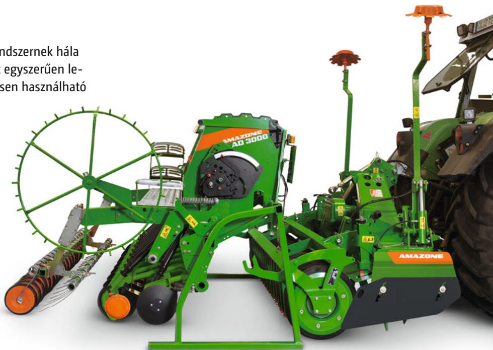
A QuickLink gyorscsatlakozó rendszer három, könnyen hozzáférhető csatlakozási pontja biztonságos, szerszám nélküli és gyors fel- és lecsatlakoztatást tesz lehetővé
