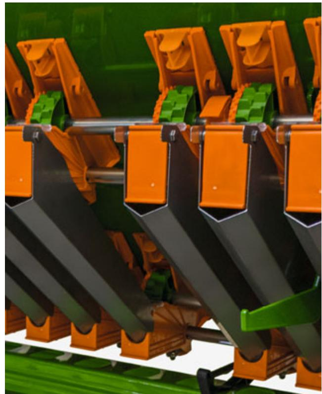
Le second produit est amené par des descentes dans les sorties du dosage de semence de la trémie principale.
