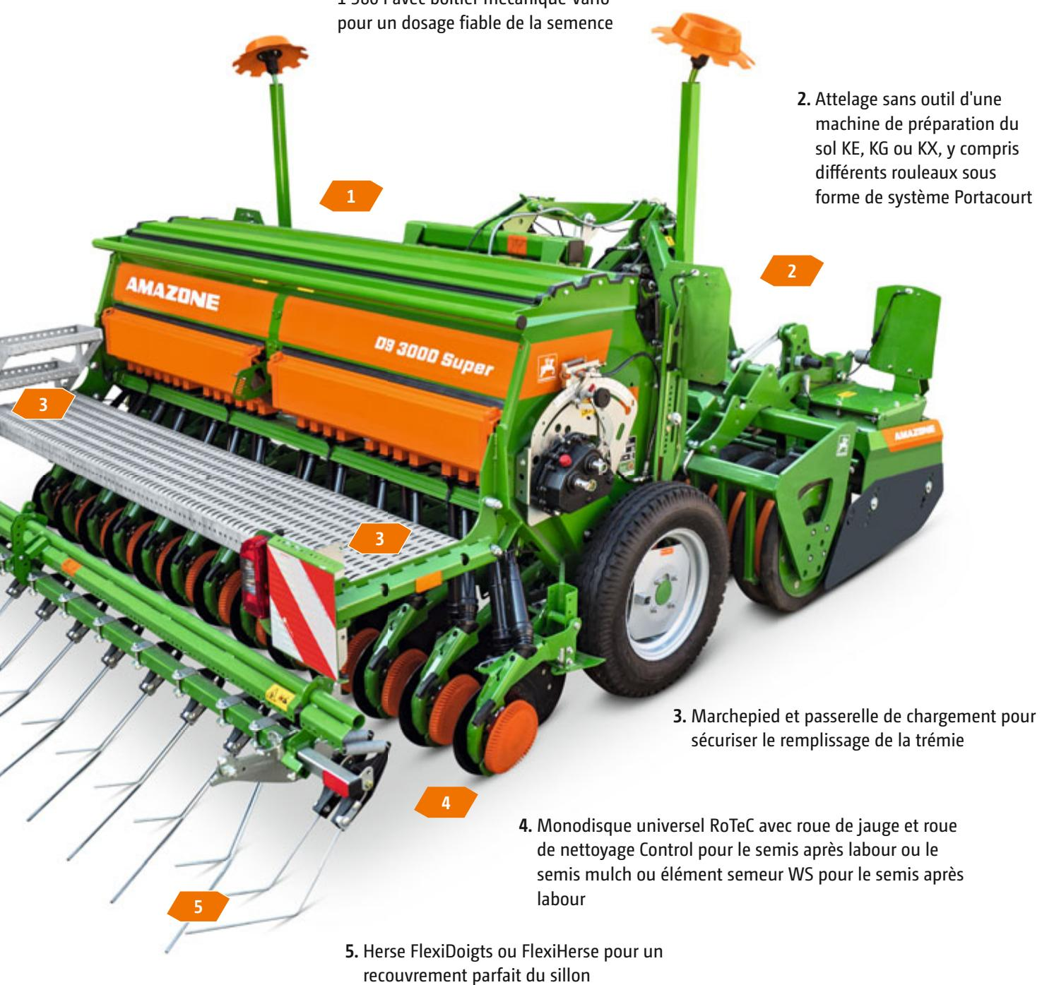
2. Attelage sans outil d'une machine de préparation du sol KE, KG ou KX, y compris différents rouleaux sous forme de système Portacourt
