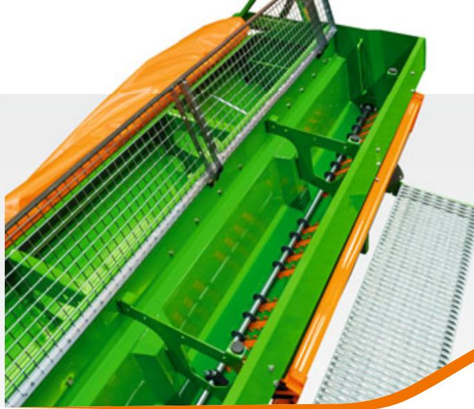
La trémie du C-Drill ajoutée ultérieurement est montée à la suite de trémie de base
