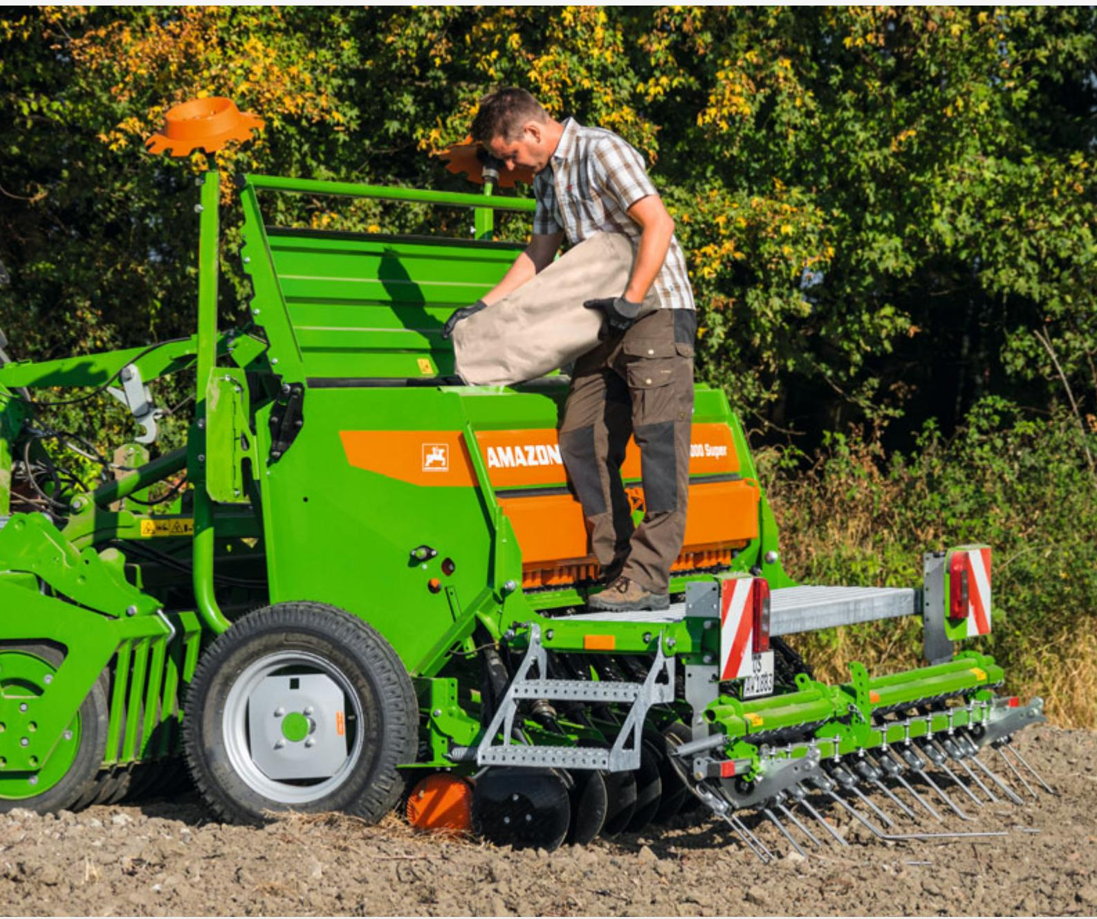
La montée sécurisée, via les marchepieds rabattables et la passerelle de chargement, permet d'accéder facilement à la trémie de semences.
