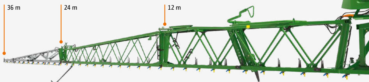
Belka polowa Super L3 o szerokości roboczej 36 m, z możliwością redukcji do 24 m i 12 m
