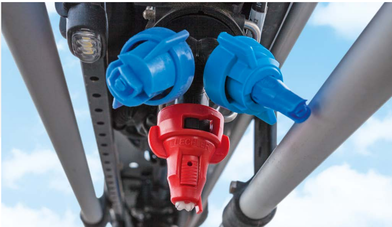
Potrójny korpus rozpylaczy AmaSwitch z przełączaniem każdego rozpylacza
