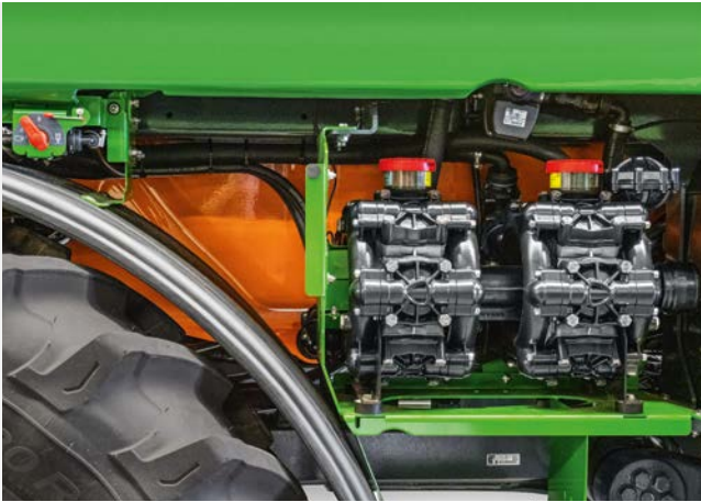
Zespół pomp po prawej stronie maszyny
