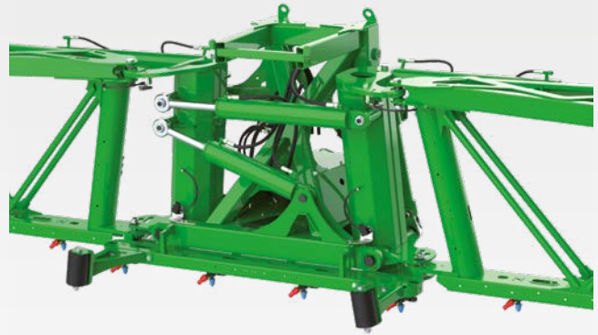
Kompensacja drgań belki polowej L3 od 39 metrów
