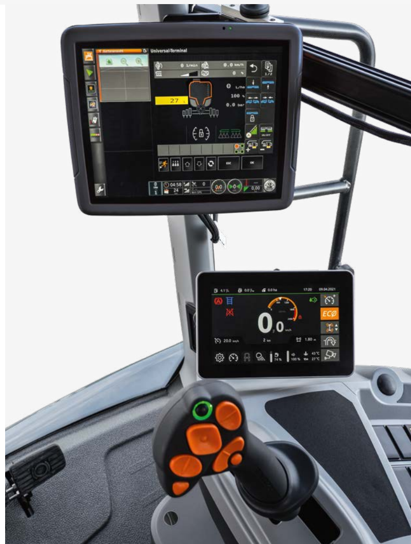
Zastosowanie dwóch terminali z terminalem ISOBUS TopCon X35 i terminalem pojazdu AmaDrive 7.0 oraz joystickiem AmaPilot +
