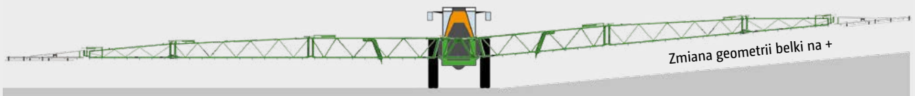
Zmiana geometrii belki (za pomocą rozkładania Flex 2)
