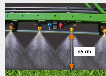
Rozpylacz 80°: Rozstaw rozpylaczy 25 cm
