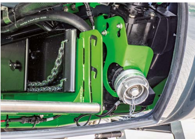
Przyłącze napełniania w schowku z automatycznym zatrzymywaniem napełniania
