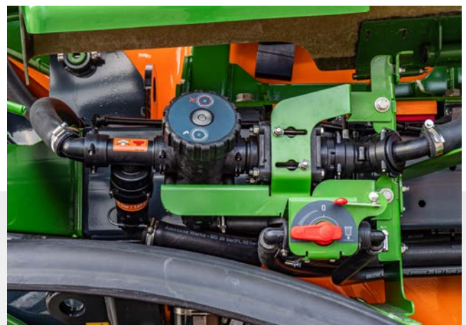
Opcja HighFlow + jest wyposażona w dodatkowy, samoczyszczący się filtr ciśnieniowy
