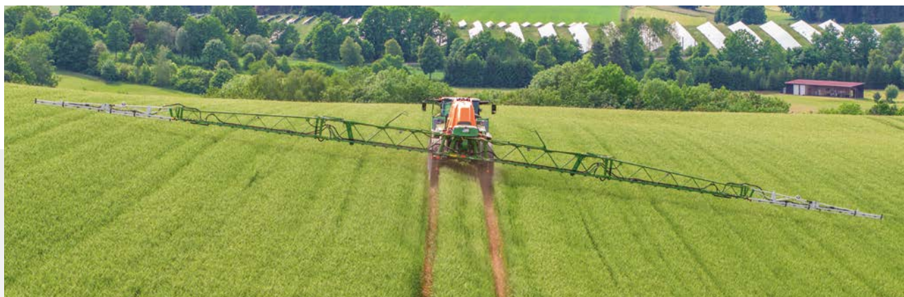
Csekély borulásveszély dombos terepen, az automatikus lejtéskompenzációnak hála
