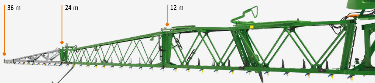
Super L3 szórókeret 36 méteres munkaszélességgel, amely 24 m és 12 m szélességre csökkenthető
