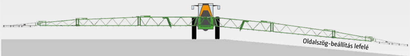
Oldalszög-beállítás lefelé (Flex-2 keretnyitás és a ContourControl funkció kombinációjával)
