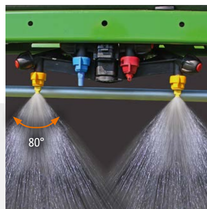
AmaSelect elektromos fúvókánkénti szakaszolás 4 részes fúvókatartóval, valamint 50 cm-es és 25 cm-es fúvókatávolsággal
