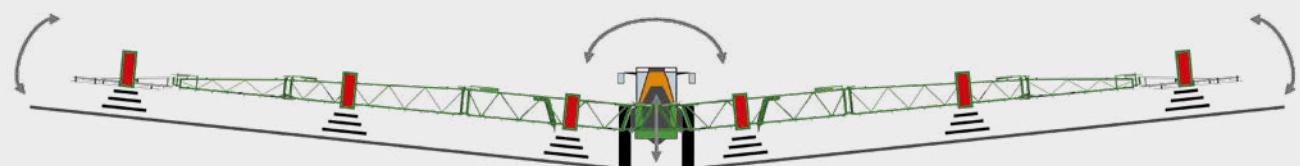
Kétoldalas oldalszög-beállítás felfelé (Flex-2 keretnyitás)
