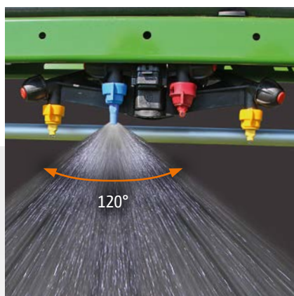
AmaSelect elektromos fúvókánkénti szakaszolás 4 részes fúvókatartóval, valamint 50 cm-es és 25 cm-es fúvókatávolsággal
