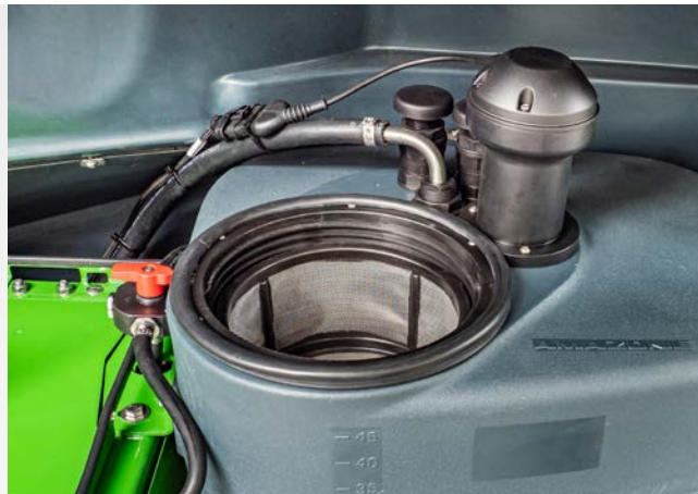
DirectInject-tartály beépített szűrővel a könnyű és biztonságos feltöltéshez
