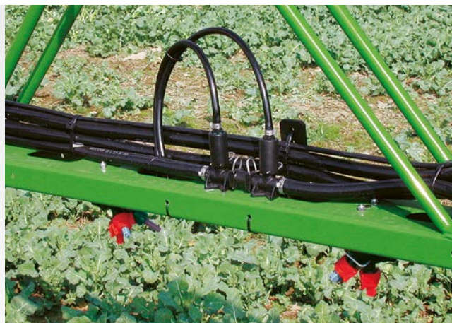
Nyomás alatti cirkulációs rendszer (DUS)
