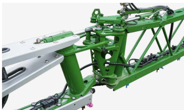
A külső tag hidraulikus előfeszítésű, lengőajtókhoz hasonló elven működő túlterhelés elleni védelme hátra, előre és felfelé térhet ki, megbízható visszatérésről gondoskodik és hosszú élettartamot szavatol.
