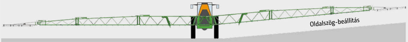
Oldalszög-beállítás (a Flex-2 keretnyitással)
