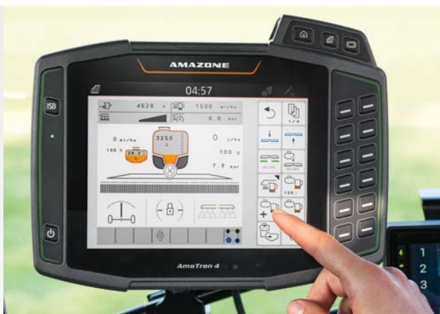
Activation de DirectInject sur le terminal AmaTron 4
