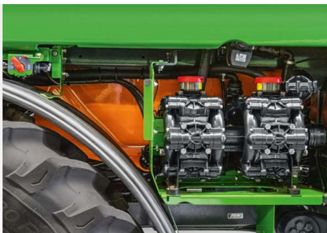
Système de pompe du côté droit de la machine
