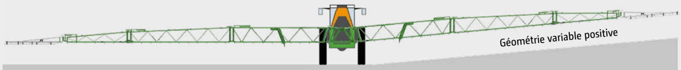
Géométrie variable (via repliage Flex 2)
