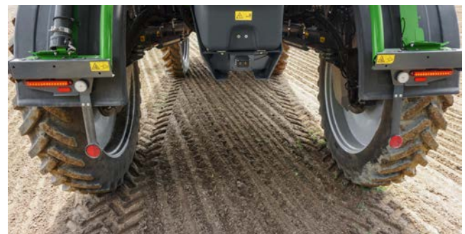
La conduite avec roues décalées préserve les plantes et le sol
