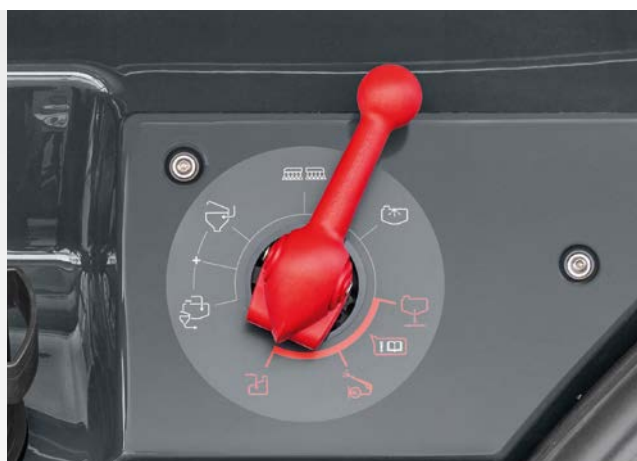
Vanne sous pression 7 voies conçue par AMAZONE
