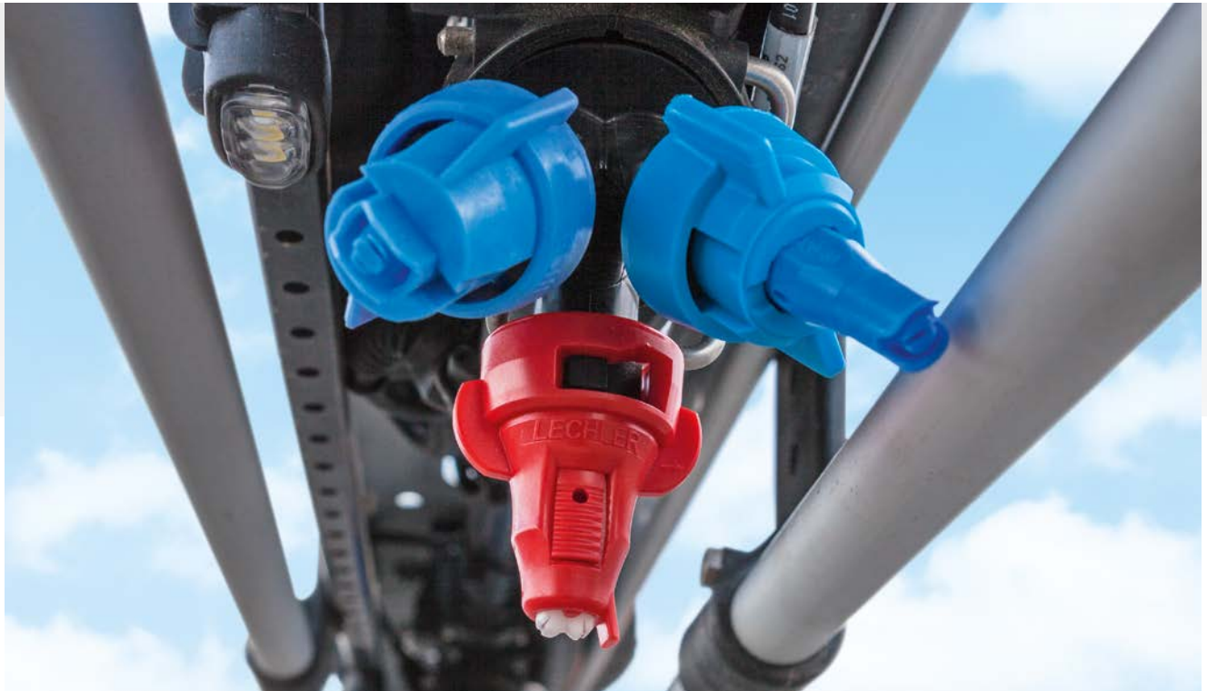
Trijets AmaSwitch avec éclairage LED individuel des buses
