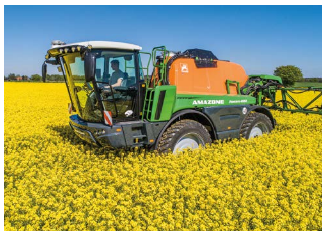
Garde au sol importante pour une application respectueuse des plantes
