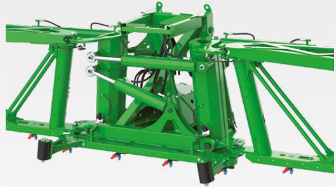
Amortissement tridimensionnel pour rampe L3 à partir de 39 mètres
