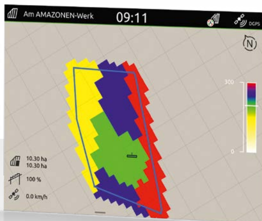
Représentation d'une carte de modulation sur l'AmaTron 4
