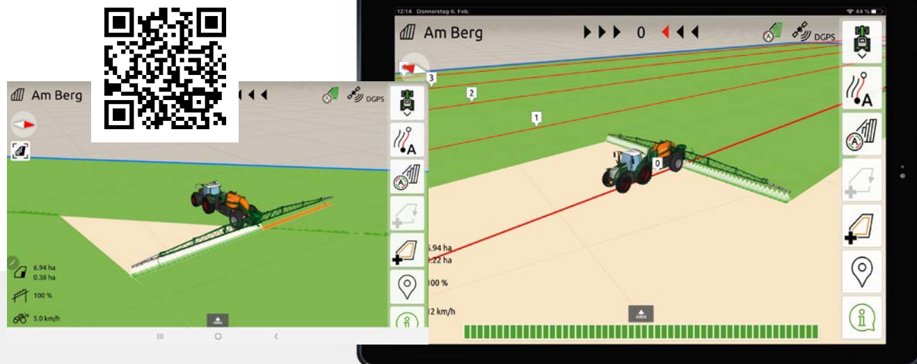
Mode d'affichage Cartes avec AmaTron Twin – Représentation claire de la machine et de ses tronçons et des boutons de commande à droite de l'écran du terminal mobile.
