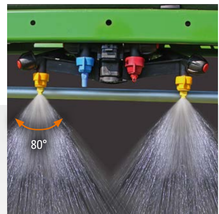
Coupe électrique individuelle des buses AmaSelect avec buse quadrijet et un écart de buses de 50 cm ou 25 cm
