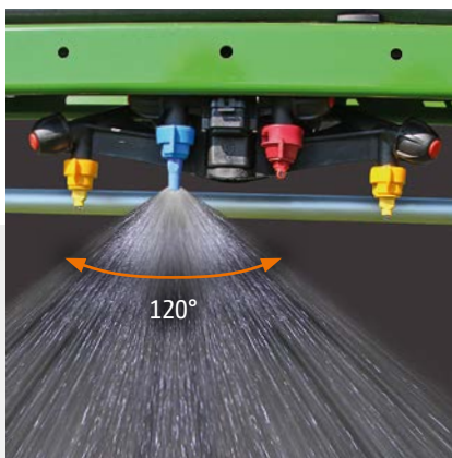
Coupe électrique individuelle des buses AmaSelect avec buse quadrijet et un écart de buses de 50 cm ou 25 cm
