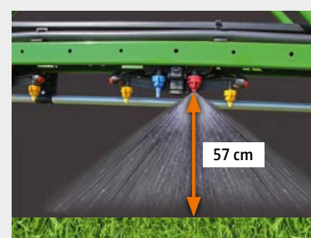
Buse 110° : Ecart entre buses 50 cm
