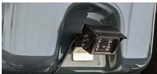
Caméra de recul à l'arrière du Pantera
