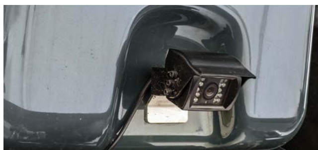
Caméra de recul à l'arrière du Pantera
