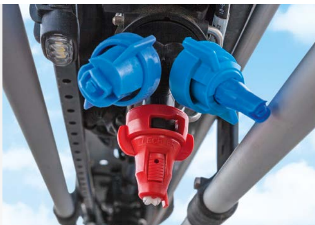
✔ Coupure électrique buse à buse AmaSwitch
