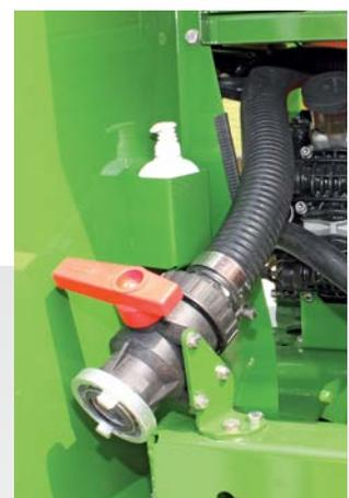
Befüllung über Druck (C- oder Kamlok-Kupplung)
