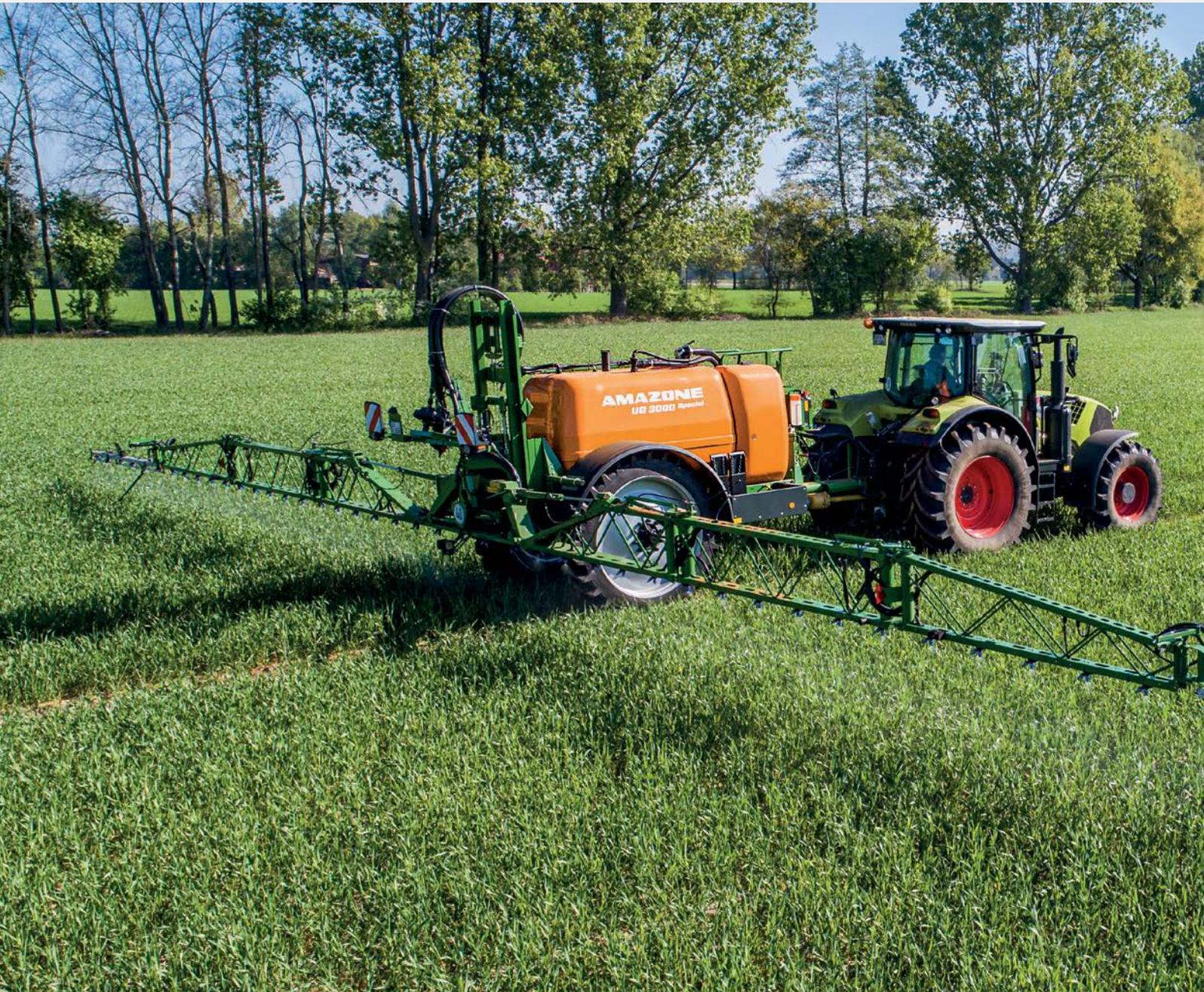
Die Anhängfeldspritze UG mit Behältervolumen von 2.200 und 3.000 l zeichnet sich durch ihre robuste und bedienungsfreundliche Bauweise aus. Mit dem Super-S2-Gestänge in Arbeitsbreiten von 15 bis 28 m ist sie eine besonders schlagkräftige Maschine.
