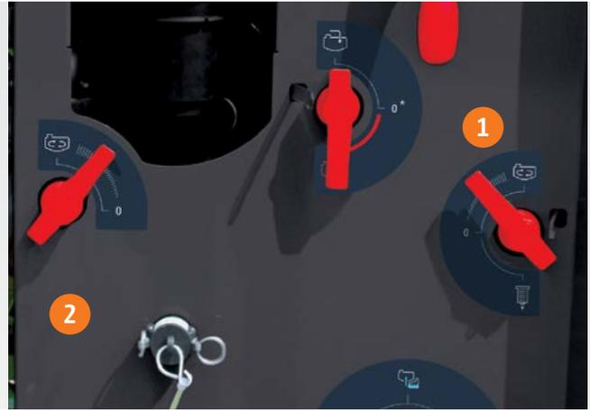
Bei AMAZONE Feldspritzen wird der Spülstrom vom selbstreinigenden Druckfilter zum Rühren benutzt (Schaltung über Pos. 1). Für hohe Rührleistungen bei geringen Zapfwellen-Drehzahlen empfiehlt sich die Pumpenausrüstung der UG Super (Schaltung über Pos. 2).
