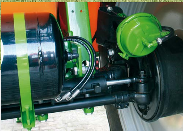
✓ Руление с поворотными кулаками AutoTrail
