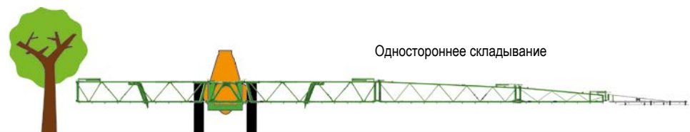
Одностороннее складывание (через преселективное складывание, складывание Profi 1 или Profi 2)
