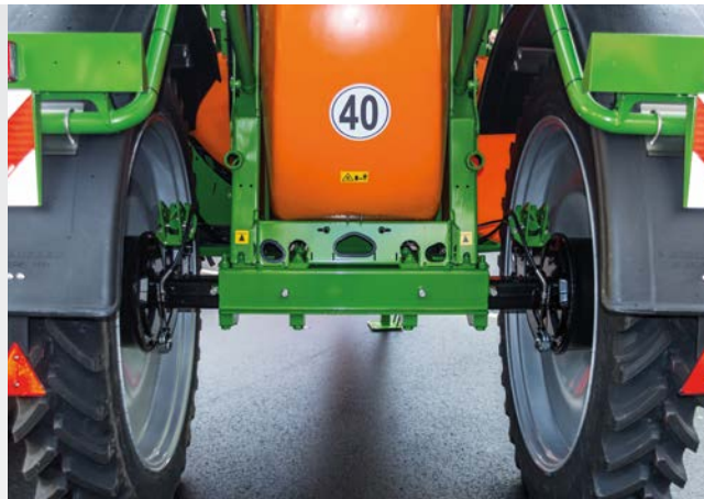
Регулируемая ось с бесступенчатой регулировкой ширины колеи от 1,50 м до 2,25 м
