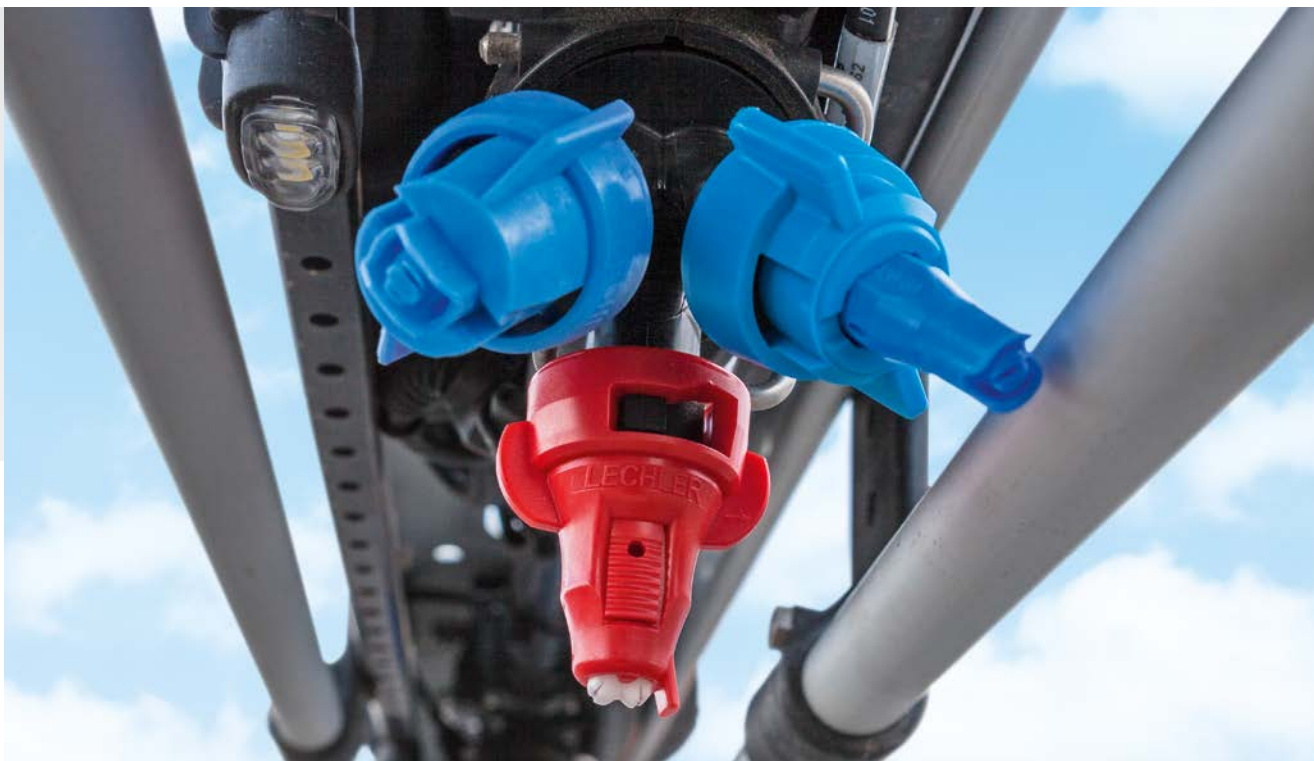
3-корпусный держатель форсунок AmaSwitch с LED-подсветкой
