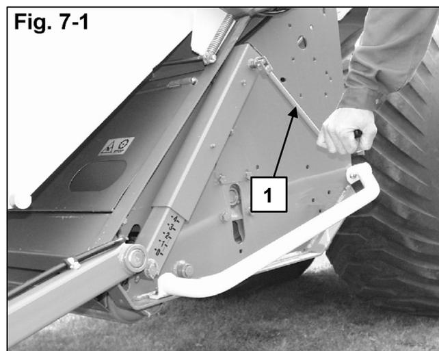
Durch Drehen der Kurbel (1) im Uhrzeigersinn wird die Stützrolle eingefahren, die Schnitthöhe somit verkleinert; durch Drehen gegen den Uhrzeigersinn wird die Stützrolle ausgefahren und die Schnitthöhe vergrößert.
